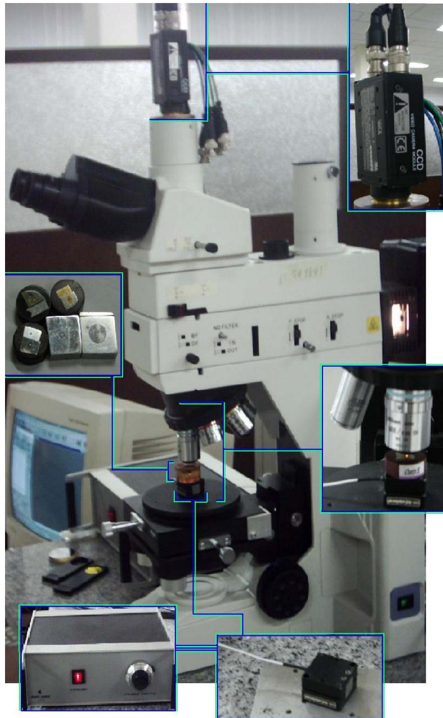
Figura 8a. Montaje experimental para el estudio de las muestra; El computador esta conectado al piezo eléctrico por medio del traslador (ampliación inferior), quien se encarga del movimiento de la muestra, información que es captada por una CCD (ampliación superior derecha), las muestras (lateral izquierdo) son ubicadas con se indica en la ampliación lateral derecho.
