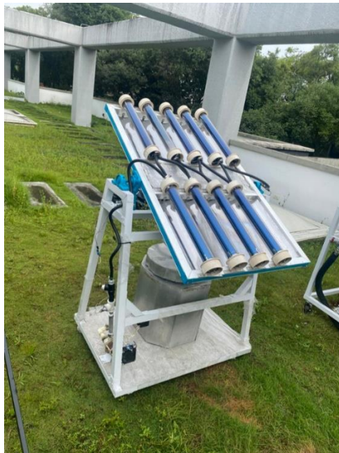
FIGURA 42. Vista frontal derecha del montaje del colector solar de tubos al vacío.
