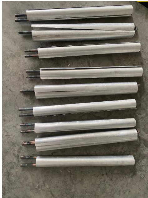
FIGURA 40. Tubos en U de cobre y aletas de Aluminio.
