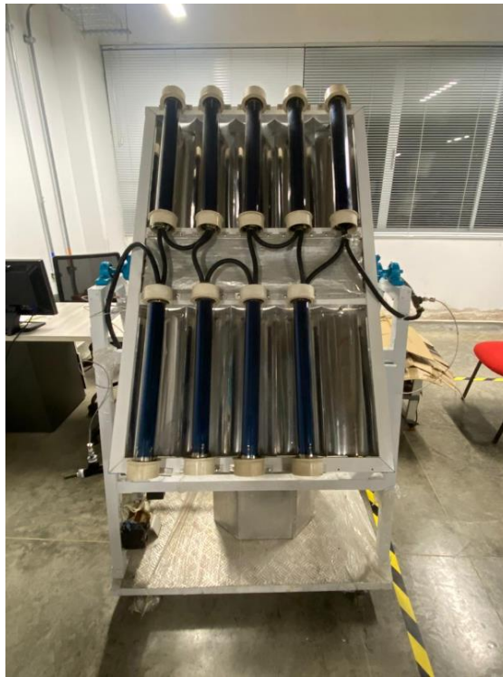
FIGURA 46. Vista frontal del montaje del colector solar de tubos al vacío.
