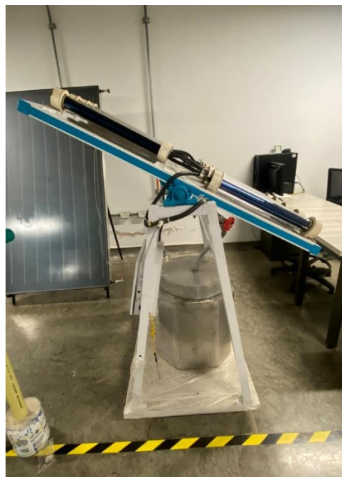
FIGURA 43. Vista lateral izquierda del montaje del colector solar de tubos al vacío.
