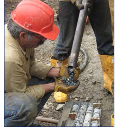
Ilustración 10. Recuperación de núcleo de roca usando perforación a rotación
