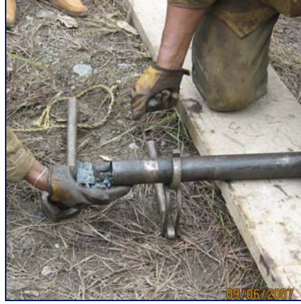
Ilustración 10. Recuperación de núcleo de roca usando perforación a rotación
