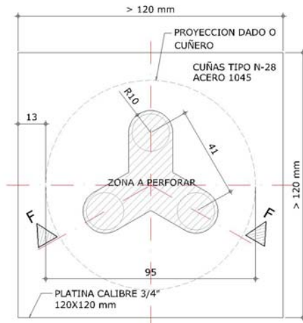
PLATINA ANCLAJE 3 CABLES Ø 1/2" ESC_1:2
