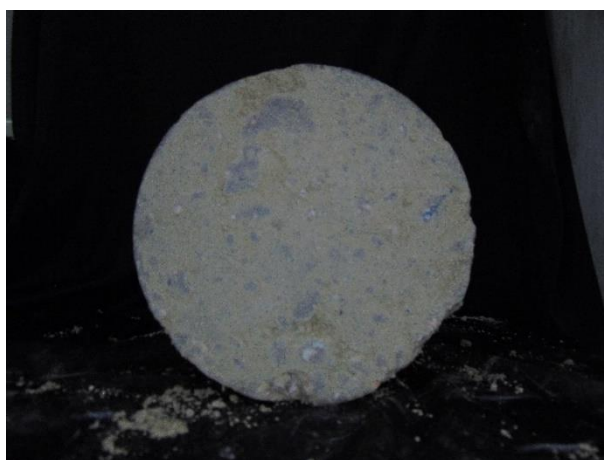
Figura M2. Probeta con humedad de 7.53% - toma cara superior
