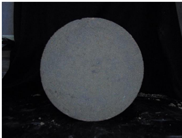
Figura M22. Probeta con humedad de 13.64% - toma cara superior
