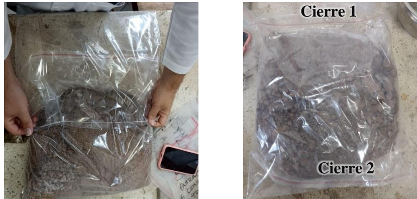
Figura B9. Almacenamiento de la mezcla suelo -agua en bolsas herméticas con cierres a 180 grados
