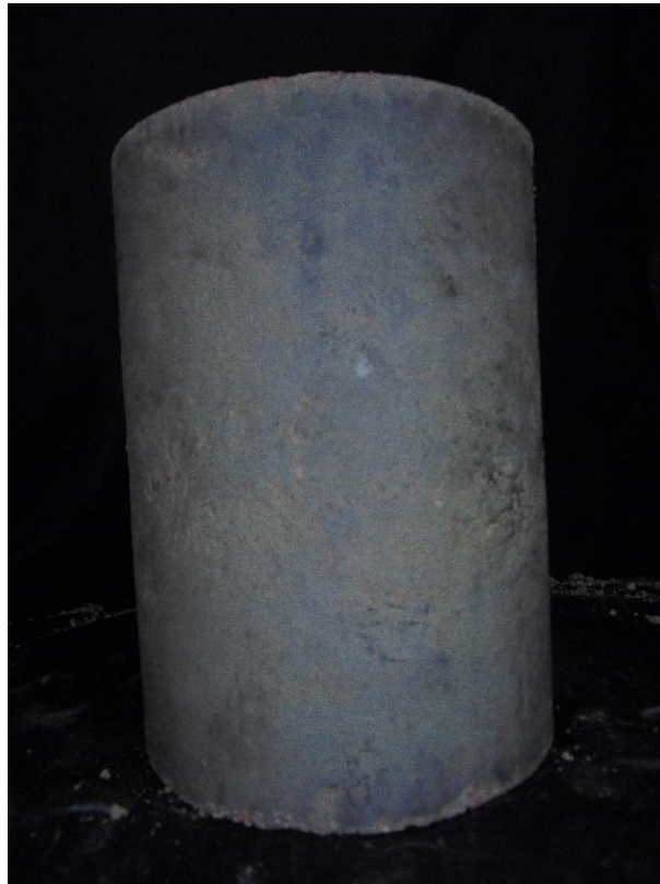
Figura M21. Probeta con humedad de 13.64% - toma lateral
