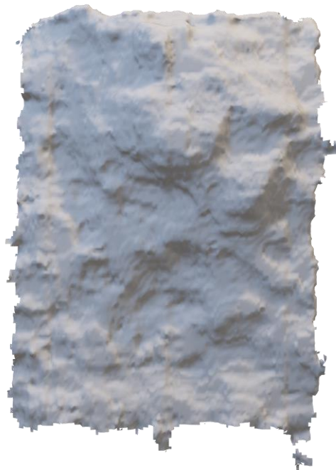
Figura M20. Probeta con humedad de 11.73% - superficie de falla 3D
