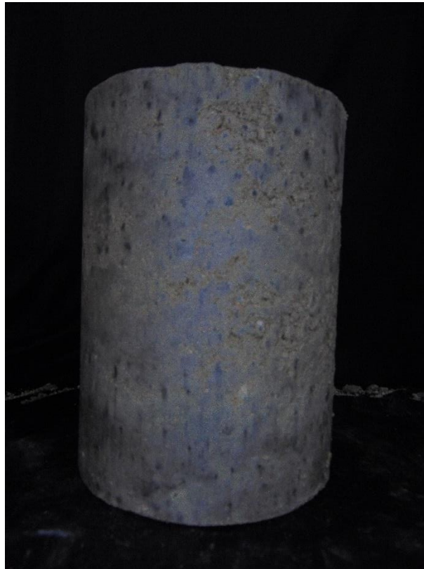
Figura M13. Probeta con humedad de 11.11% - toma lateral
