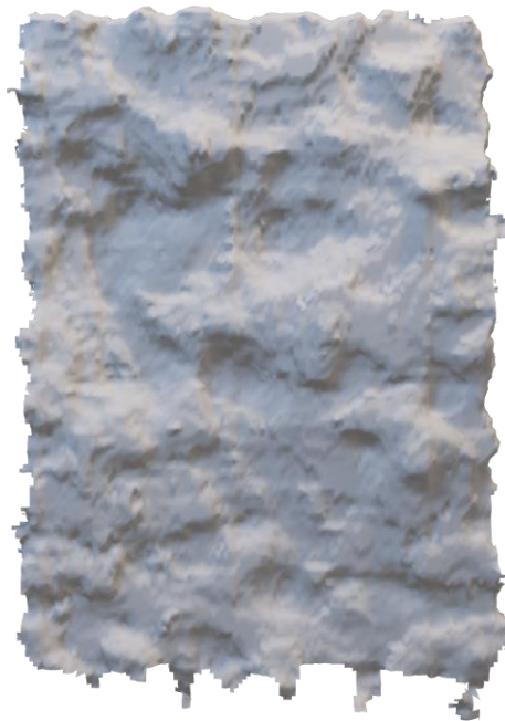
Figura M24. Probeta con humedad de 13.64% - superficie de falla 3D
