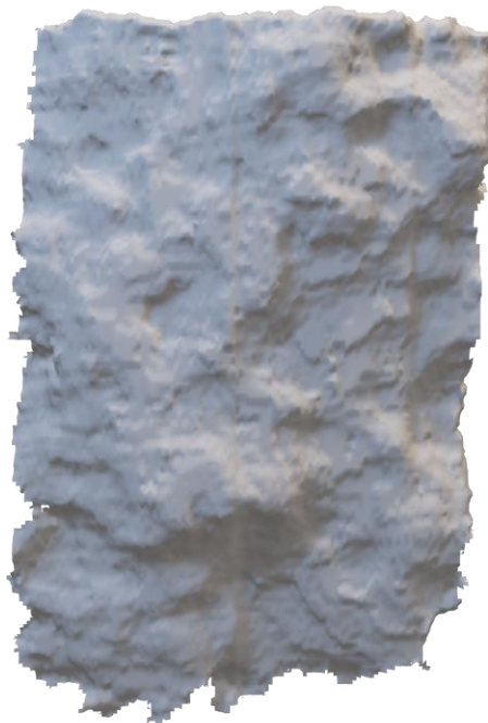
Figura M4. Probeta con humedad de 7.53% - superficie de falla 3D
