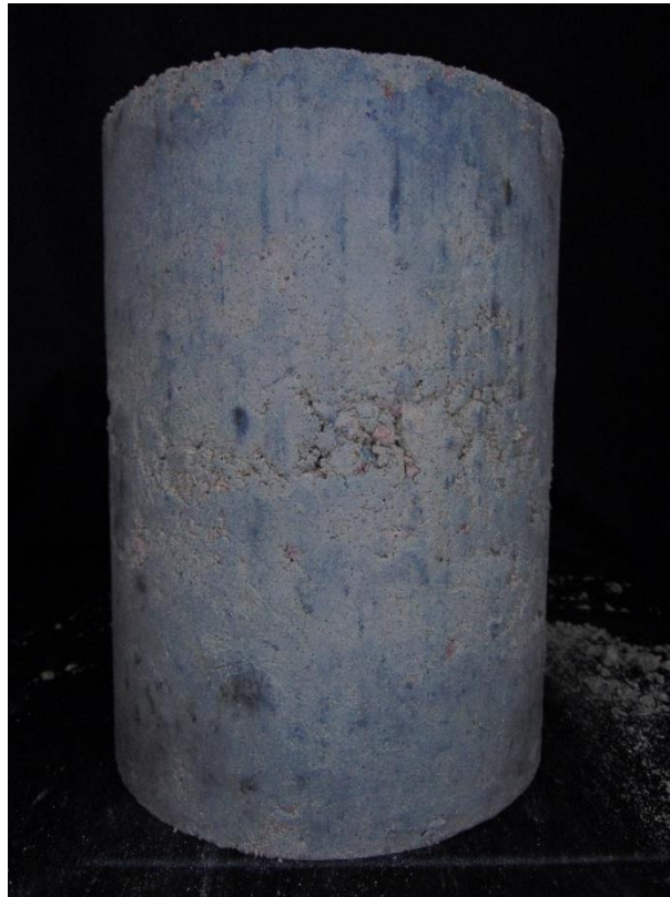
Figura N9. Probeta con humedad de 12.11% - toma lateral
