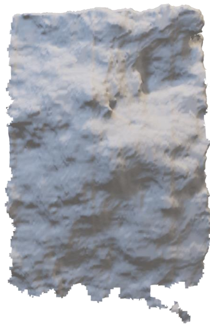
Figura M12. Probeta con humedad de 10.50% - superficie de falla 3D
