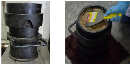
Figura B12. Molde 30 cm de altura y nivelación de la superficie de la probeta
