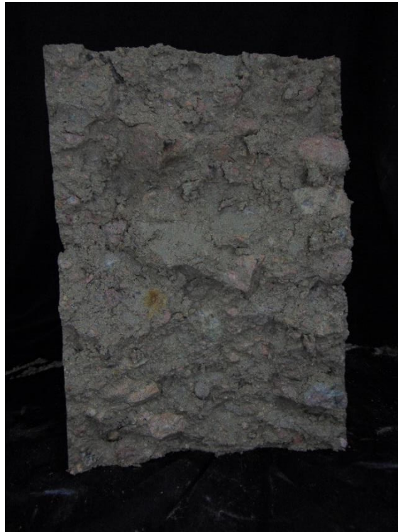
Figura M23. Probeta con humedad de 13.64% - toma después de la falla
