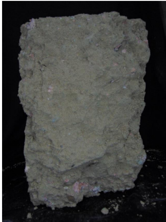
Figura M3. Probeta con humedad de 7.53% - toma después de la falla
