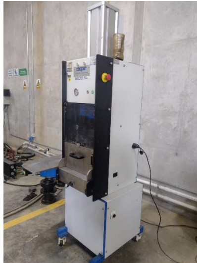
Figura 3. Compactador giratorio ubicado en el Centro de caracterización de materiales-UIS
