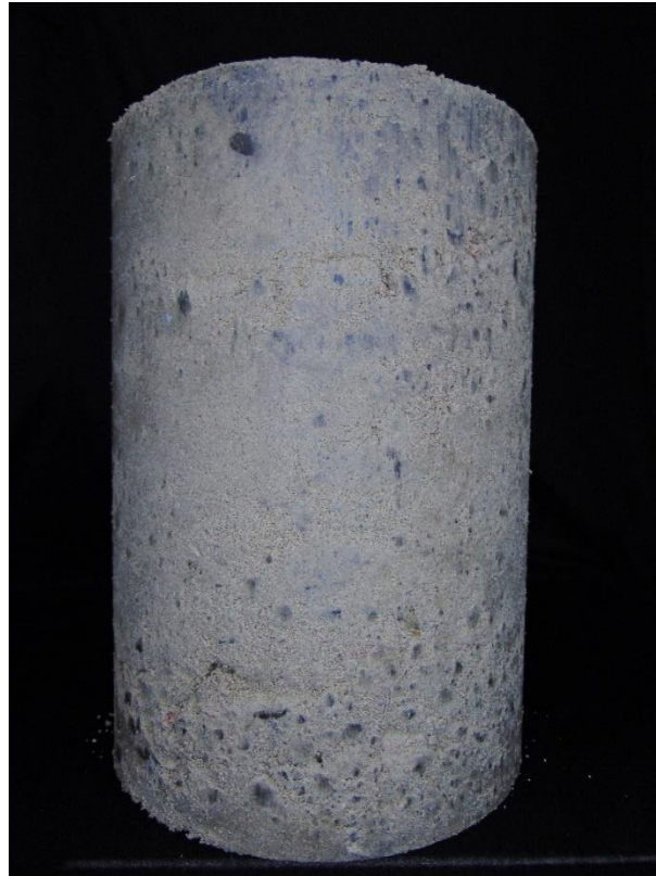
Figura N1. Probeta con humedad de 9.05% - toma lateral
