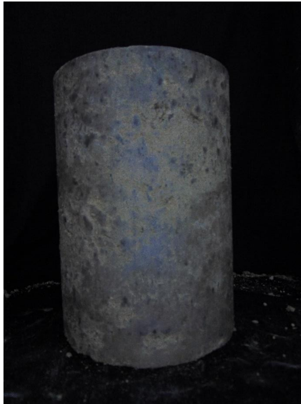
Figura M5. Probeta con humedad de 9.29% - toma lateral
