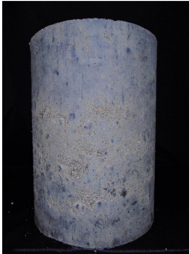
Figura N5. Probeta con humedad de 10.74% - toma lateral
