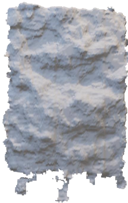
Figura M16. Probeta con humedad de 11.11% - superficie de falla 3D
