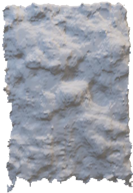
Figura M8. Probeta con humedad de 9.29% - superficie de falla 3D
