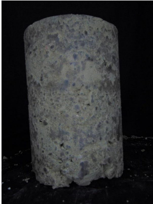
Figura M1. Probeta con humedad de 7.53% - toma lateral
