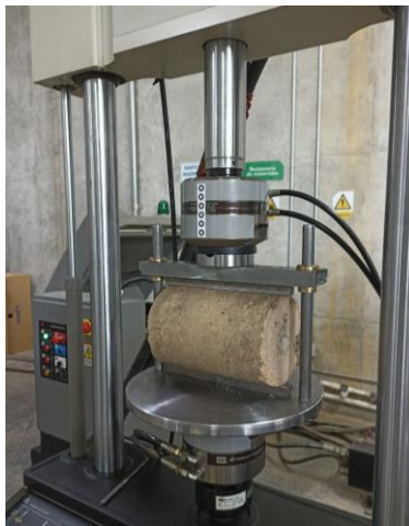
Figura 6. Montaje de la probeta para ensayo ITS
