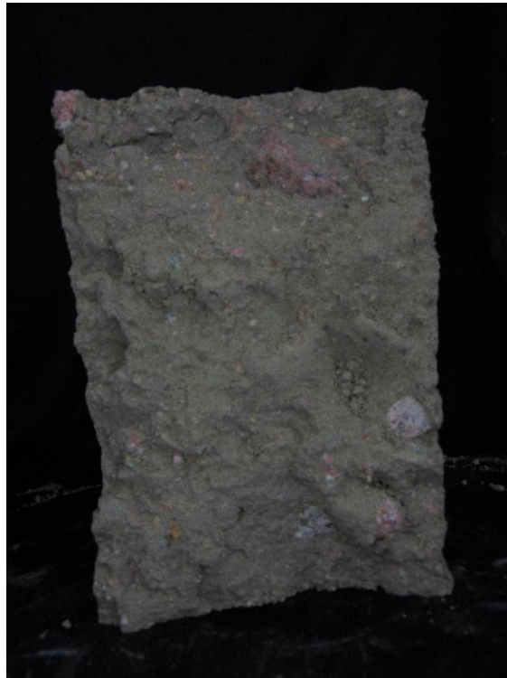
Figura M7. Probeta con humedad de 9.29% - toma después de la falla
