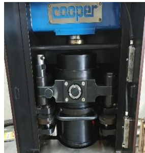
Figura B15. Molde dentro de la cámara de compactación
