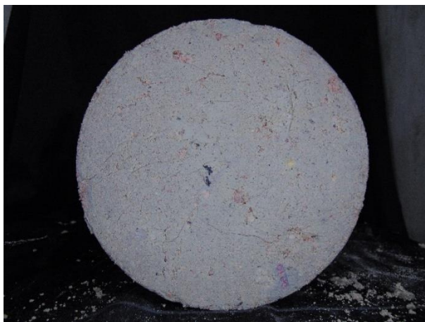
Figura N14. Probeta con humedad de 13.31% - toma cara superior
