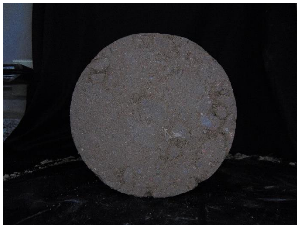
Figura M10. Probeta con humedad de 10.50% - toma cara superior
