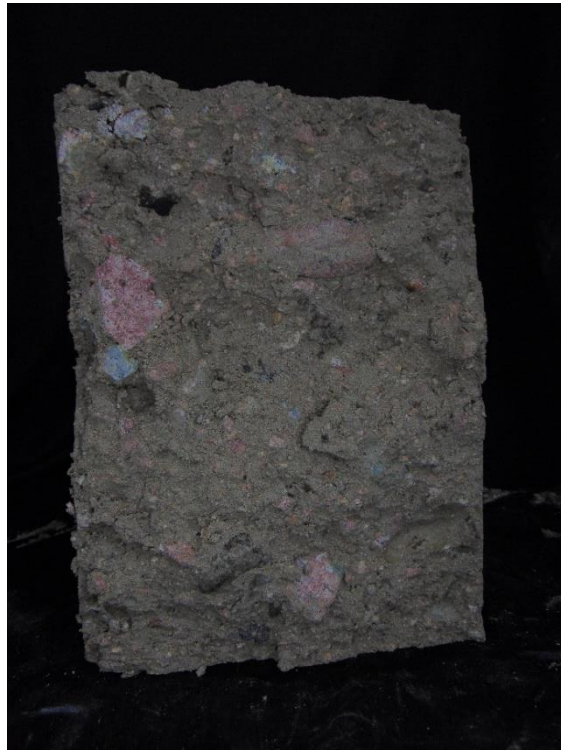
Figura M15. Probeta con humedad de 11.11% - toma después de la falla
