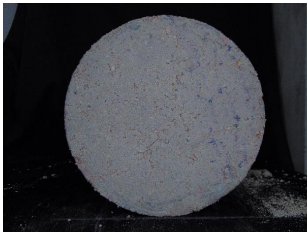
Figura N10. Probeta con humedad de 12.11% - toma cara superior
