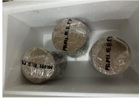
Figura B23. Almacenamiento de las probetas en la cava
