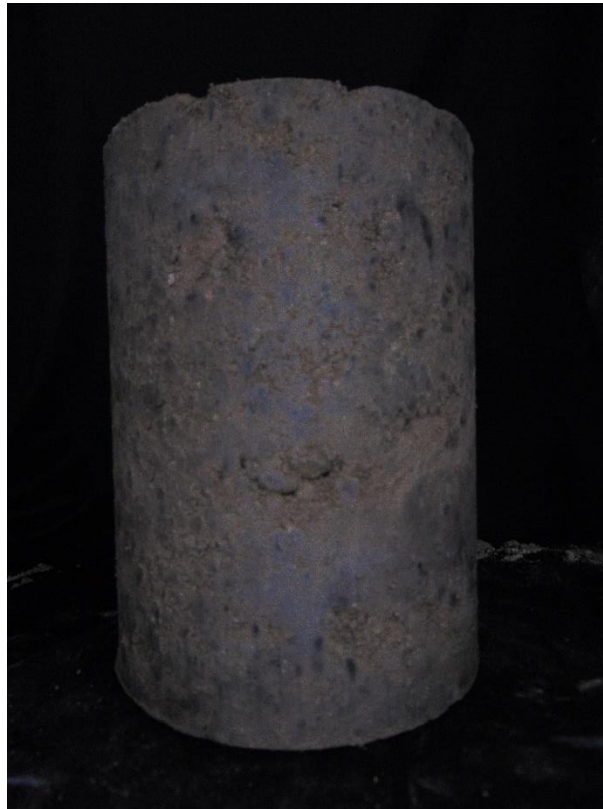
Figura M9. Probeta con humedad de 10.50% - toma lateral
