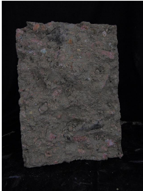
Figura M19. Probeta con humedad de 11.73% - toma después de la falla
