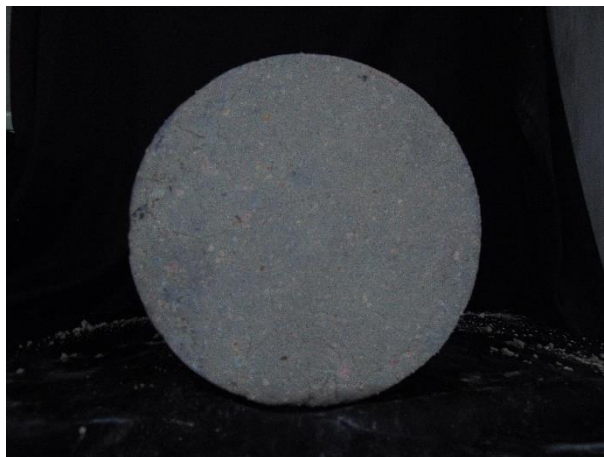
Figura M18. Probeta con humedad de 11.73% - toma cara superior
