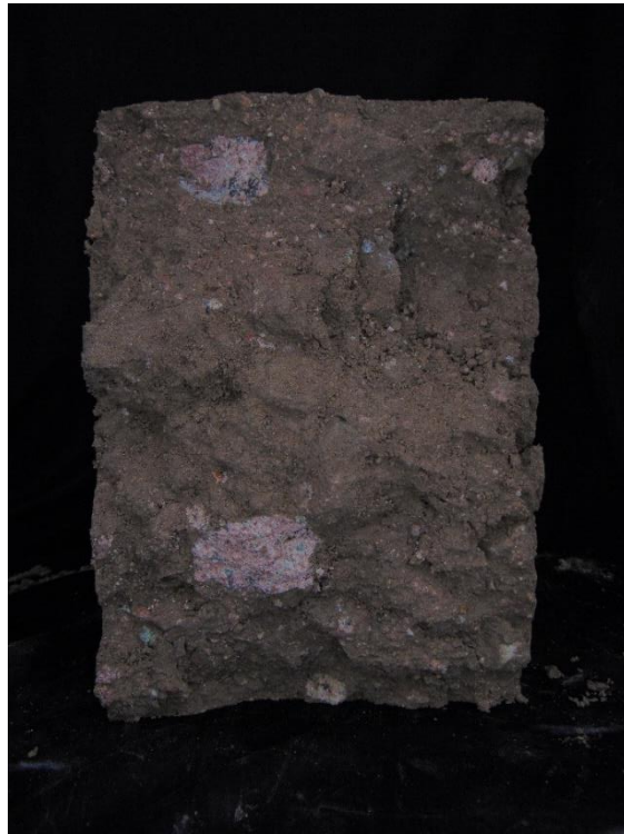
Figura M11. Probeta con humedad de 10.50% - toma después de la falla
