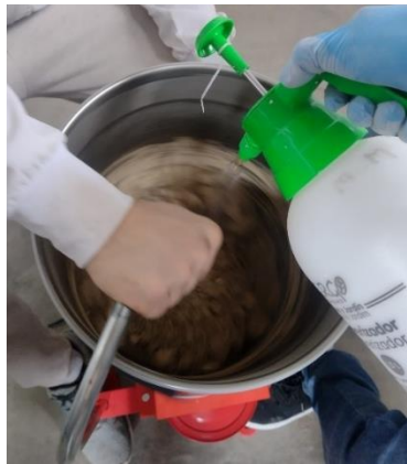
Figura B8. Mezclado del material en la mezcladora mecánica
