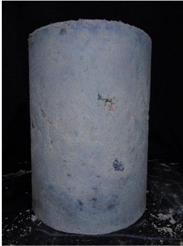
Figura N13. Probeta con humedad de 13.31% - toma lateral
