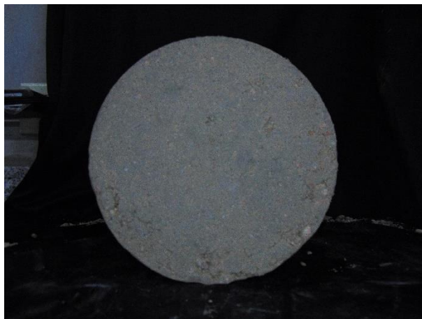
Figura M14. Probeta con humedad de 11.11% - toma cara superior
