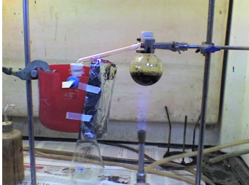
Fotografía 1. Ejecución determinación de ceras – Destilación.
