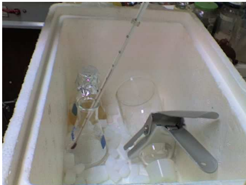
Fotografía 10. Ejecución determinación de ceras – cristalización.
