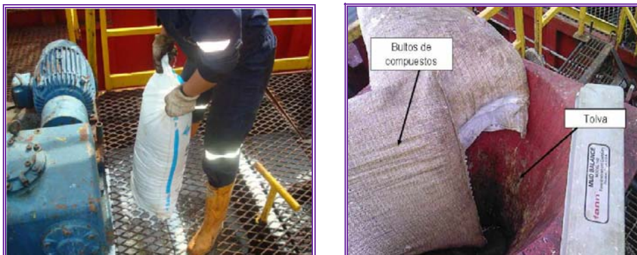
Foto 7. Rejillas y Tolva.
