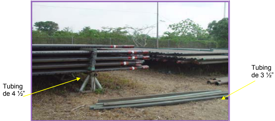
Foto 24. Tubería de Producción. Bodega de ECP APIAY.
