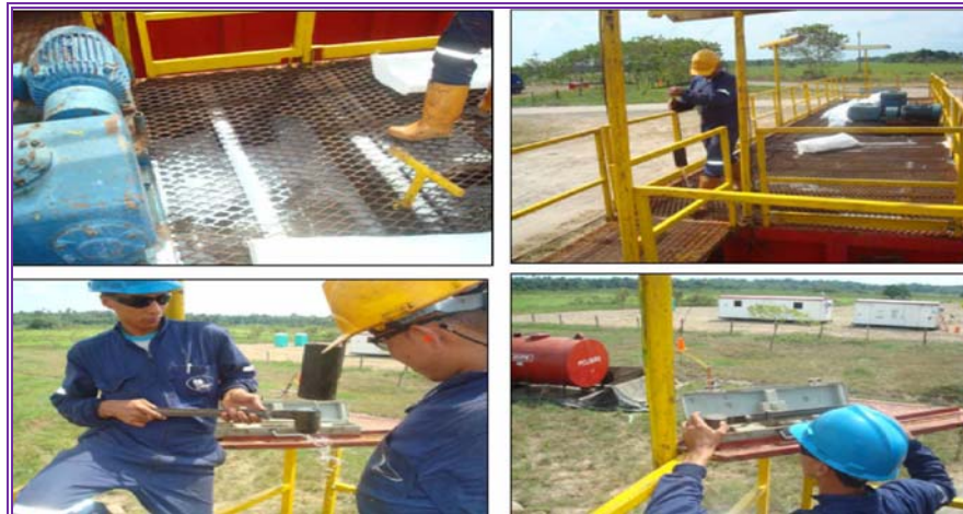
Foto 9. Realizar prueba de densidad en balanza de lodo.
