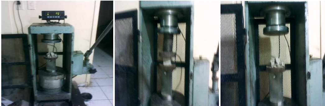
Figura 6. Equipos para medir la resistencia a la compresión
