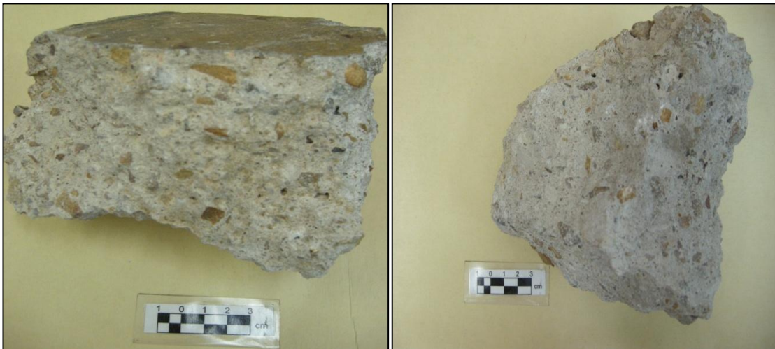
Figura 7. Fotografía a escala macroscópica del residuo de concreto
