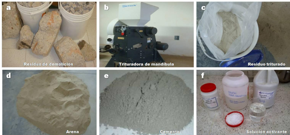
Figura 4. Equipos y materiales utilizados en la preparación de los materiales. (a) Residuo de demolición. (b) Trituradora de mandíbula. (c) Material triturado y tamizado. (d) Arena. (e) Cemento. (f) Solución activante.
