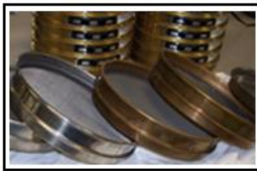
Figura 34. Mallas para la evaluación de la granulometría
