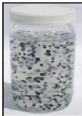
Figura 30. Monoprop suspendido en fluido de fractura
