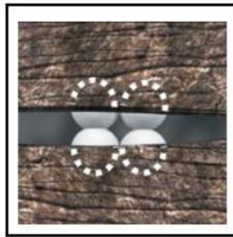
Figura 15. Embedment del material propante en la formación
