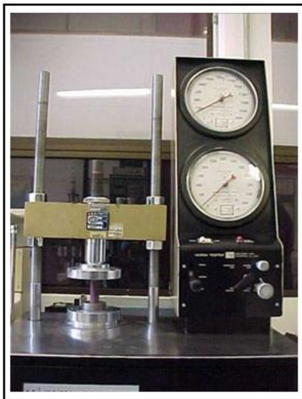
Figura 36. Equipo prueba de crushing
