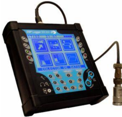
Figura 43. Dispositivo para medir vibraciones en las máquinas.
