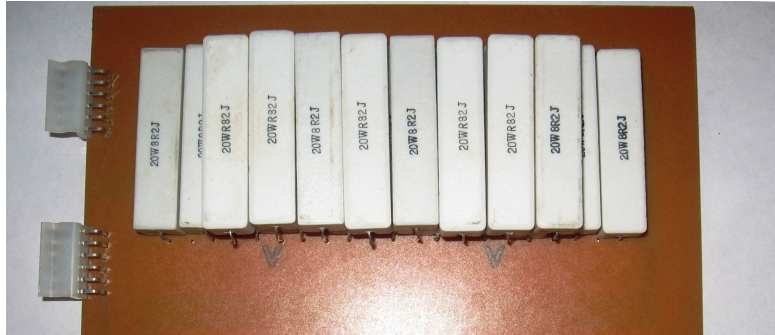
Figura 26: Fotografía de la batería de resistencias en paralelo.
