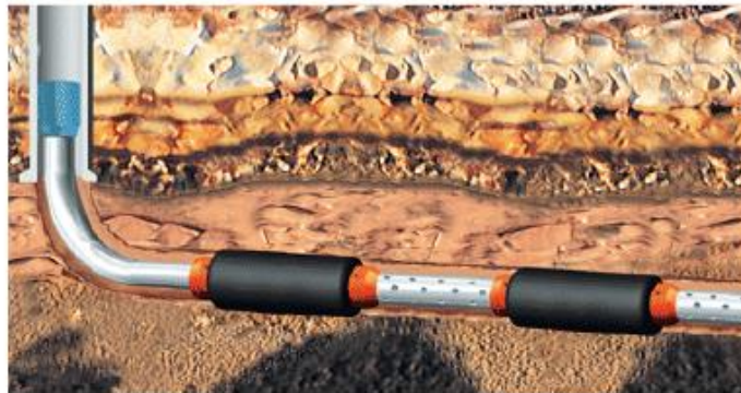
Figura 3. Completamiento con liner ranurado.
