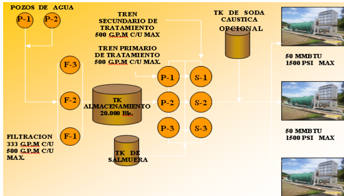
Figura 18. Diagrama de flujo 2 - tratamiento del agua
