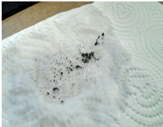
Figura 64. Muestra con Corrosión en toalla
