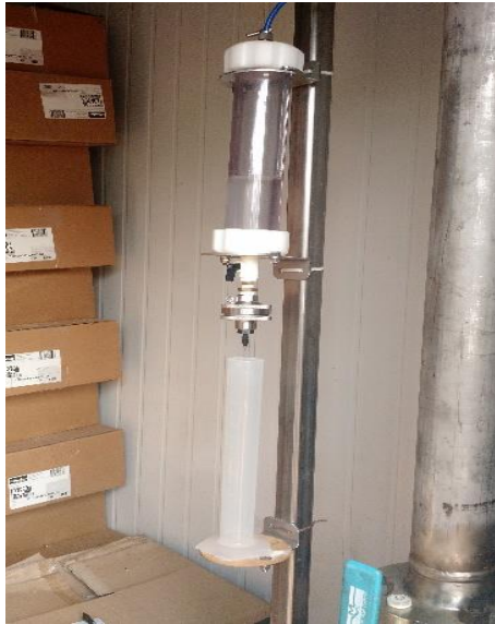
Figura 62. Montaje de prueba de filtrabilidad en campo
