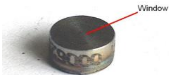
Figura 45. Imagen de la cápsula que contiene el isótopo radiactivo de Am241.
