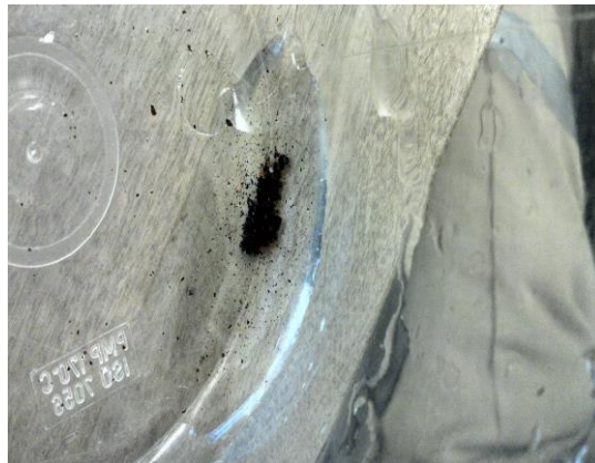
Figura 63. Muestra con Corrosión en recipiente.
