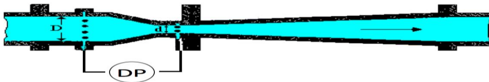
Figura 39. Representación esquemática del flujo a través del Venturi.
