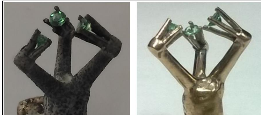
Figura 97. Árbol de aleación cobre-liga-indio con esmeraldas pre-engastada obtenido con el revestimiento sílice-yeso
