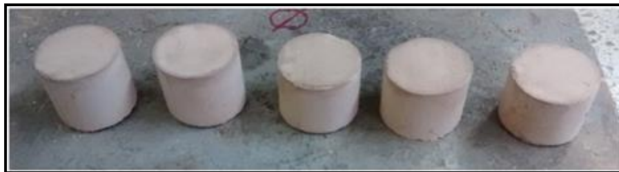
Figura 52. Probetas de las mezclas chamota/yeso después de 5 ciclos de choque térmico
