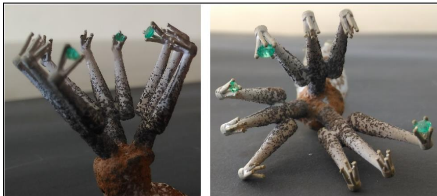
Figura 80. Árbol con esmeraldas pre-engastada obtenido con el revestimiento chamota-yeso, con aleación plata-cobre
