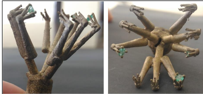
Figura 84. Árbol con esmeraldas pre-engastada obtenido con el revestimiento mullita-yeso y aleación plata-cobre
