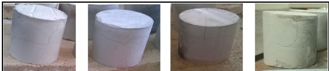
Figura 59. Probetas de las mezclas mullita/yeso después del choque térmico
