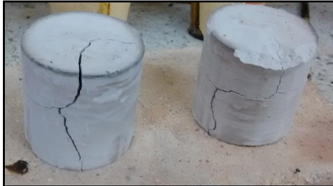
Figura 65. Probetas de las mezclas sílice/yeso después del choque térmico
