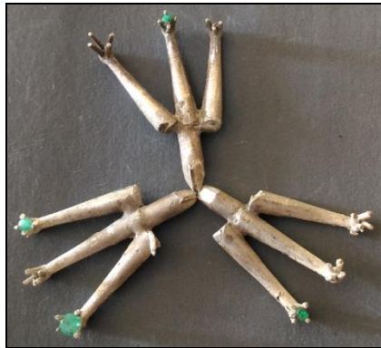
Figura 78. Árbol con esmeraldas pre-engastada obtenido con el revestimiento comercial y aleación plata-cobre
