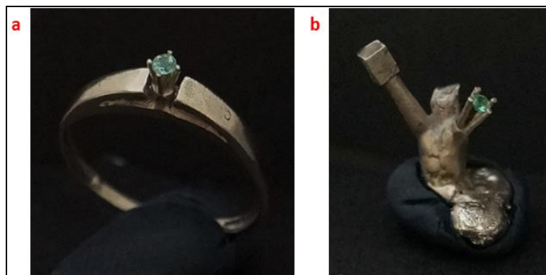
Figura 101. Piezas fundidas con aleación oro-liga-indio con esmeraldas pre-engastadas obtenidas con el revestimiento comercial
