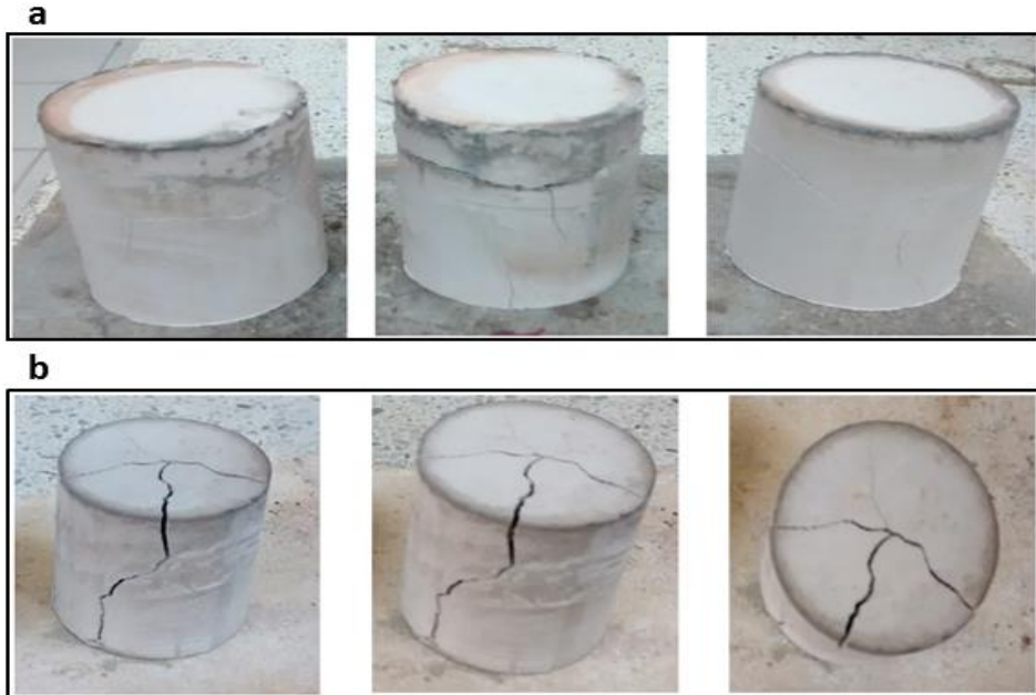
Figura 72. Probetas de las mezclas sílice calcinada/yeso después del tratamiento térmico (a) y después de tres ciclos de choque térmico (b)
