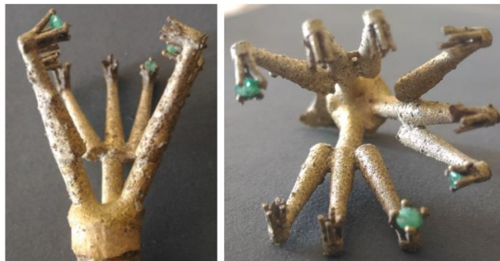
Figura 86. Árbol de aleación plata-cobre con esmeraldas pre-engastada obtenido con el revestimiento sílice-yeso
