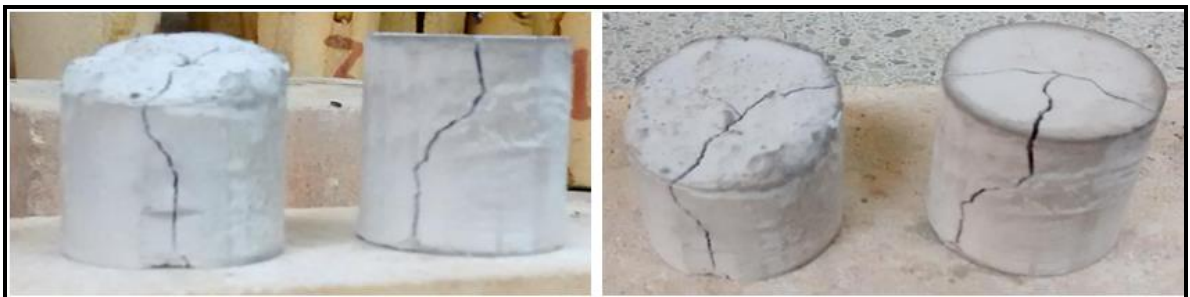
Figura 70. Probetas de las mezclas sílice calcinada/yeso después del tratamiento térmico
