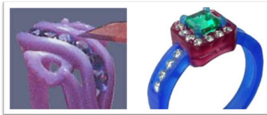
Figura 2. Fijación de gemas en modelo de cera
