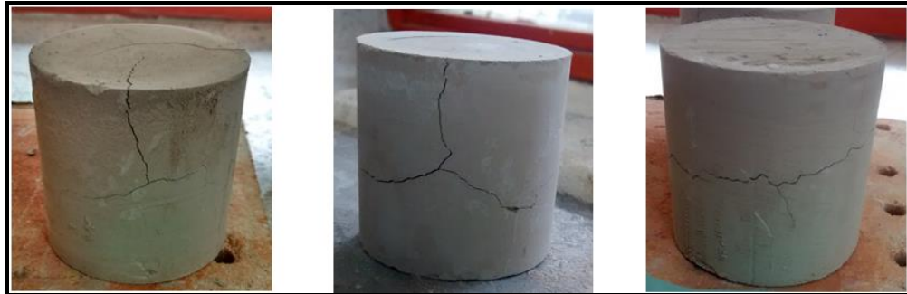
Figura 44. Probetas de las mezclas de magnesita calcinada/yeso después de 5 ciclos de choque térmico
