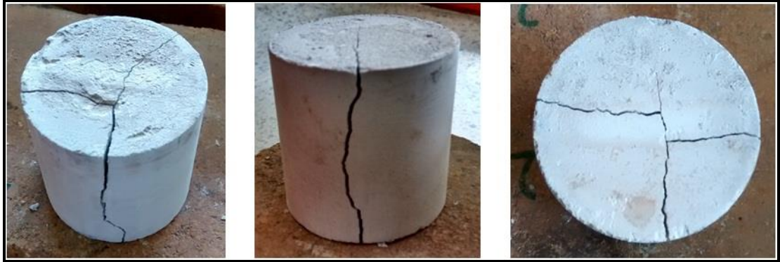
Figura 30. Probetas de revestimiento comercial después de 5 ciclos de choque térmico
