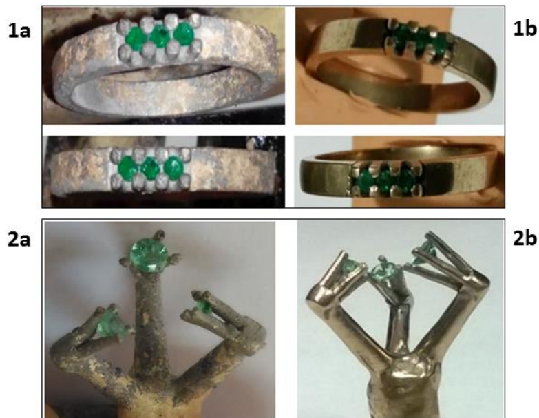
Figura 92. Piezas fundidas con aleación cobre-liga-indio y revestimiento mullita/yeso, antes (1a,2a) y después del pulido (1b,2b)
