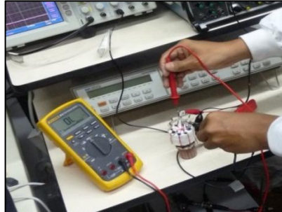
Figura 117. Verificación de corto circuito
