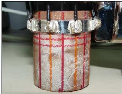
Figura 123. Posicionamiento de PZT en la muestra. Señales Primas
