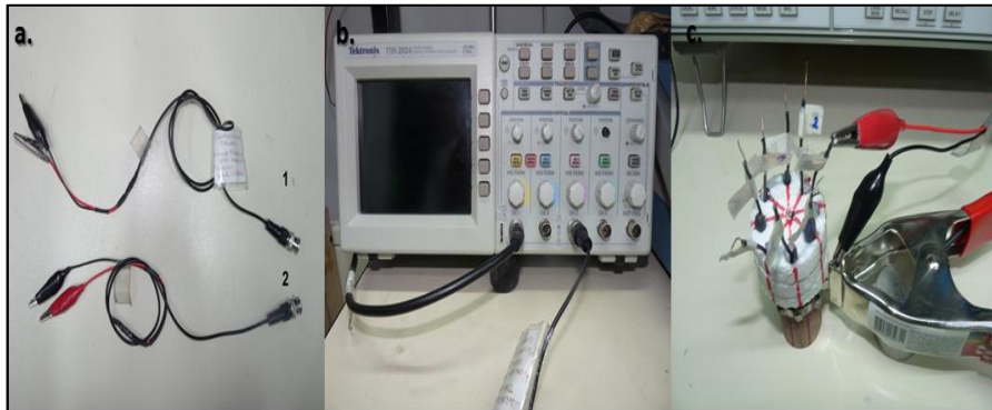
Figura 115. a. Cables (2x1). b. Conexión al Osciloscopio (Channel 3). c. Conexión a la muestra.
