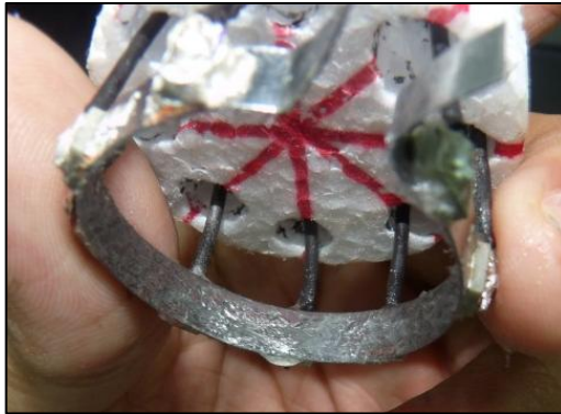
Figura 109. Adhesión de grasa de vacío parte interna de la abrazadera
