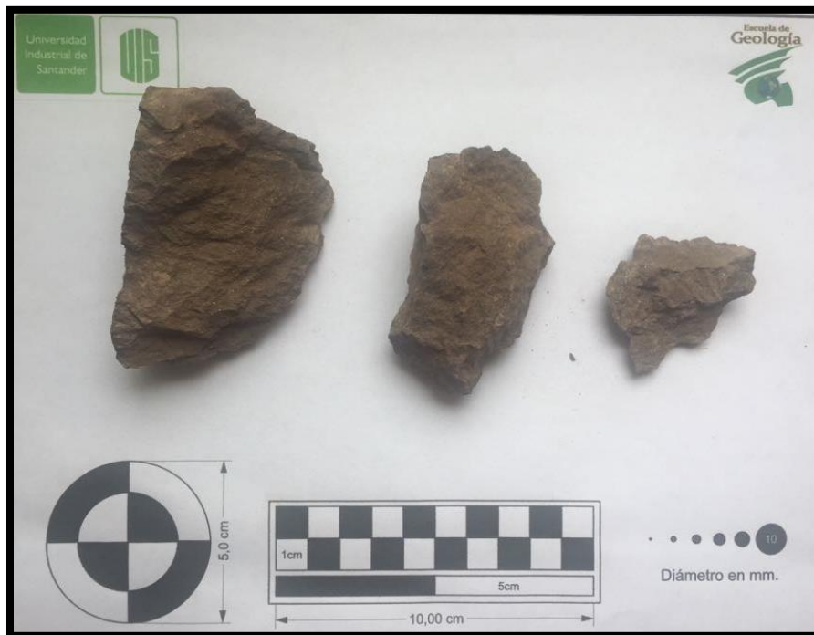
Figura 30. Limolita arcillosa. Muestra JA-GR-08.
