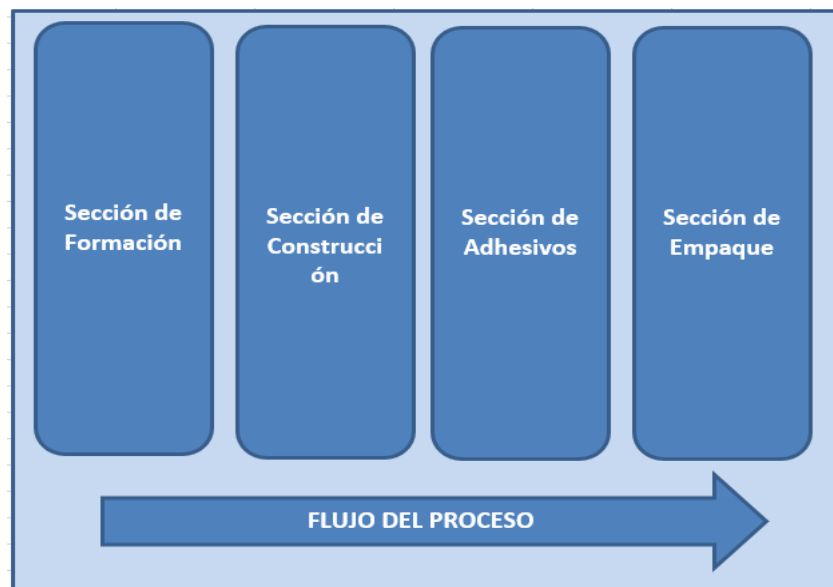
Figura 25. Secciones de una máquina pañalera
