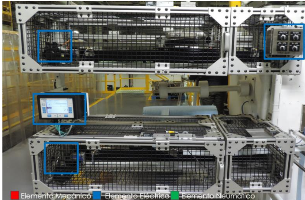
Figura 29. Componentes del Desenrollador del Surge.
