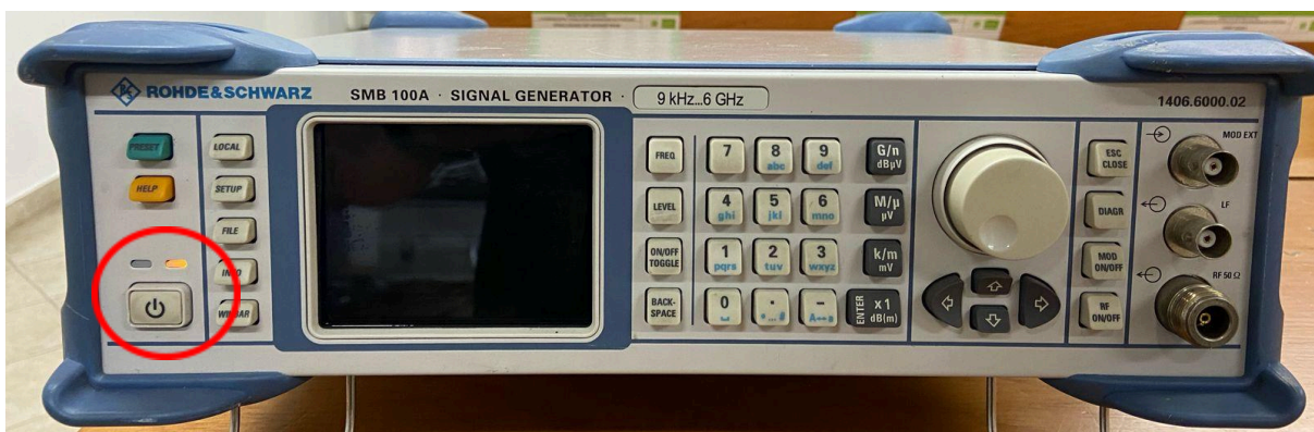
Figura 1. Botón de encendido del generador de señales.
