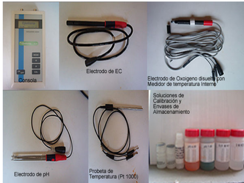
Foto2. Elementos de la sonda.
