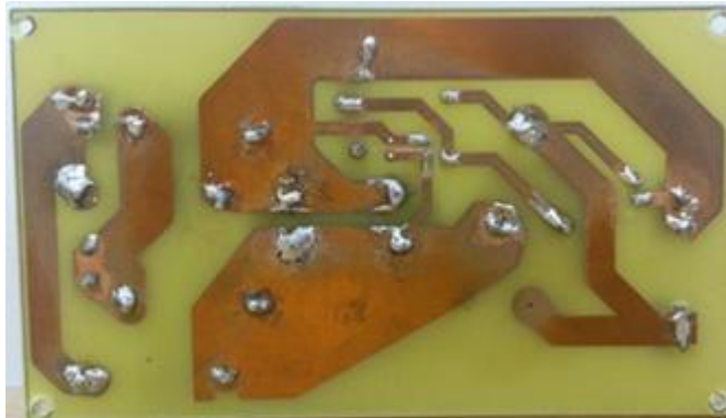
Figura 3636. Detalle de las pistas de la PCB de la etapa de potencia para el circuito de aislamiento y adecuación de las señales de conmutación.
