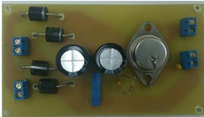
Figura 3535. PCB de la etapa de potencia para la etapa de aislamiento y adecuación de las señales de conmutación.
