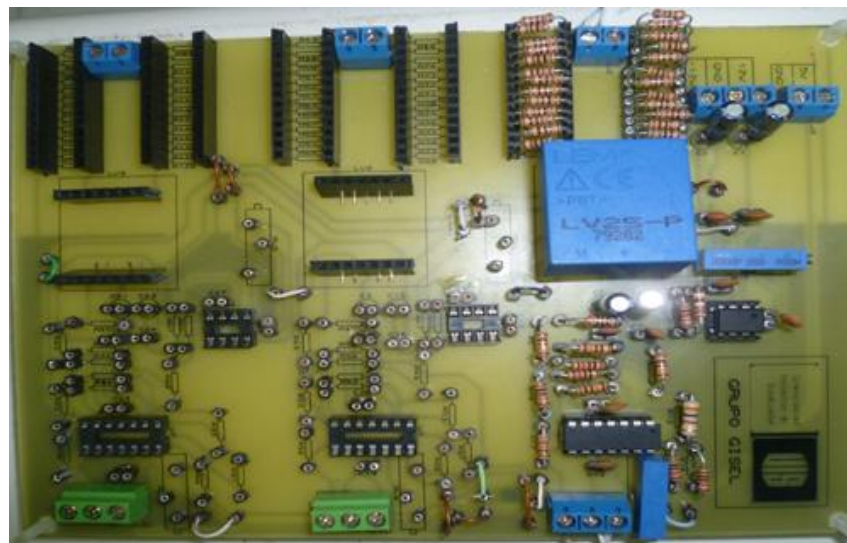
Figura 3232. PCB para el sensado de tensión.
