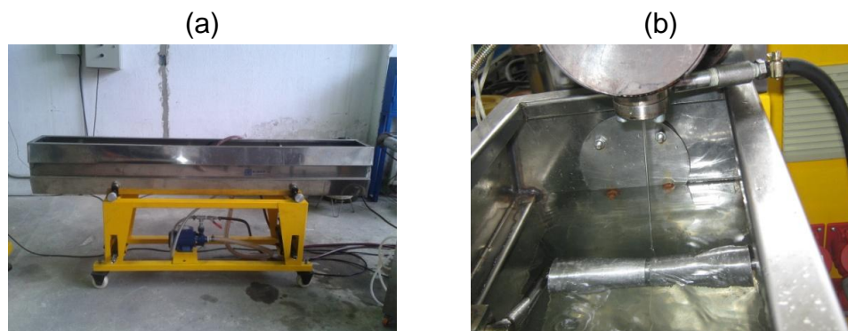
Figura 11. (a) Tanque de enfriamiento. (b) Rodillos del tanque de enfriamiento. Fuente: Autor
