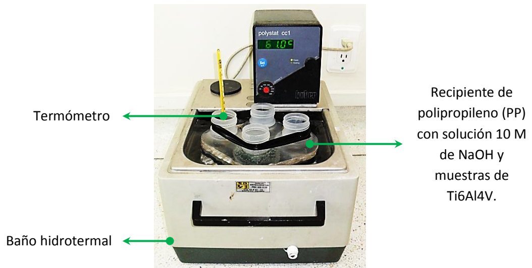
Figura 6. Montaje utilizado para el tratamiento alcalino de la aleación Ti6Al4V en solución 10 M de NaOH a 60°C por 24 horas.
