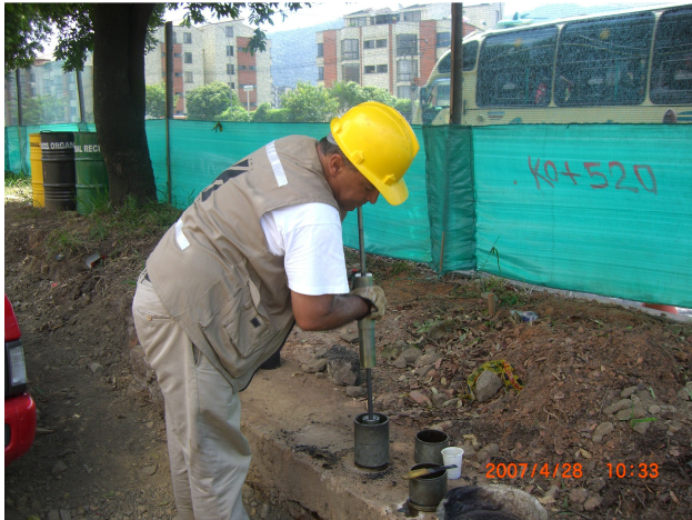
FIGURA 8. EXTRACCIÓN DE NÚCLEOS PARA VERIFICAR ESPESORES DE LA CAPA DE MDC-3
