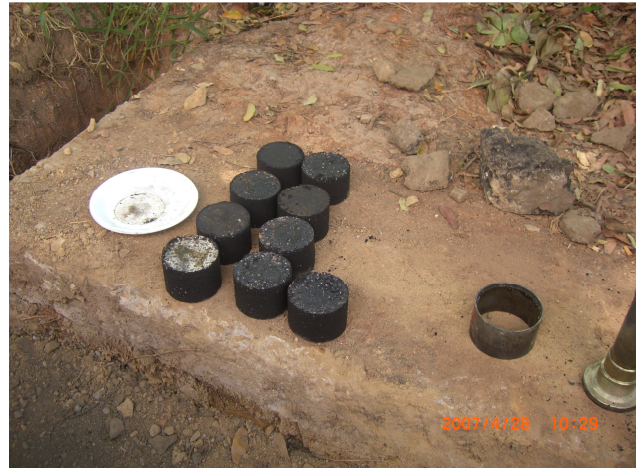
FIGURA 8. EXTRACCIÓN DE NÚCLEOS PARA VERIFICAR ESPESORES DE LA CAPA DE MDC-3
