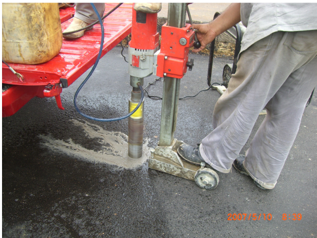
FIGURA 8. EXTRACCIÓN DE NÚCLEOS PARA VERIFICAR ESPESORES DE LA CAPA DE MDC-3
