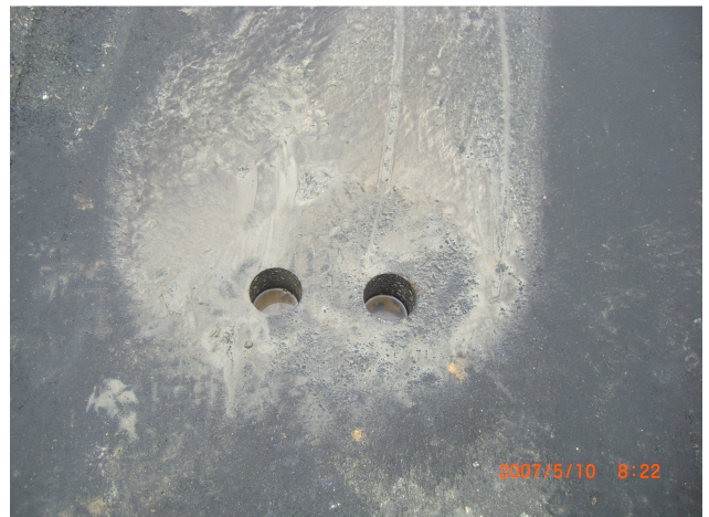
FIGURA 8. EXTRACCIÓN DE NÚCLEOS PARA VERIFICAR ESPESORES DE LA CAPA DE MDC-3
