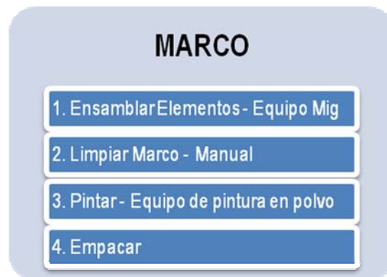
Figura No. 49 Descripción del proceso de ensamblaje y terminado de un marco.
