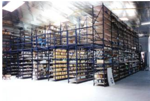
Figura No. 12 Mezzanine para cargas medias y livianas.
