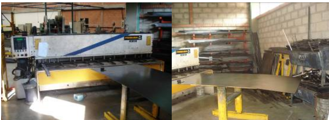
Figura No. 31 Centro de Corte. Maquina cizalla y puesto de trabajo.
