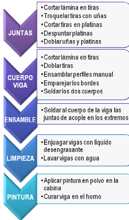
Figura No. 52 Descripción de los procesos de fabricación de vigas.
