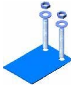
Figura No. 43 Zapato para cargas semi-pesadas y pesada, con perforaciones.
