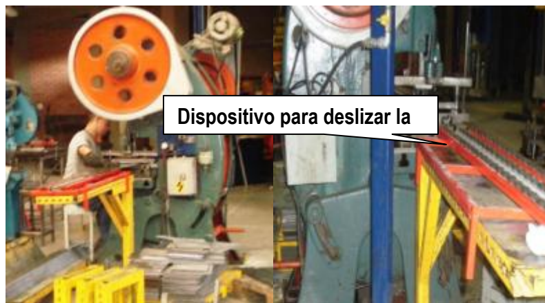
Figura No. 82 Troqueladora 70Ton con dispositivo instalado.
