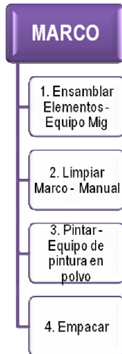
Figura No. 68 Descripción de los procesos de ensamblaje y terminación del marco.
