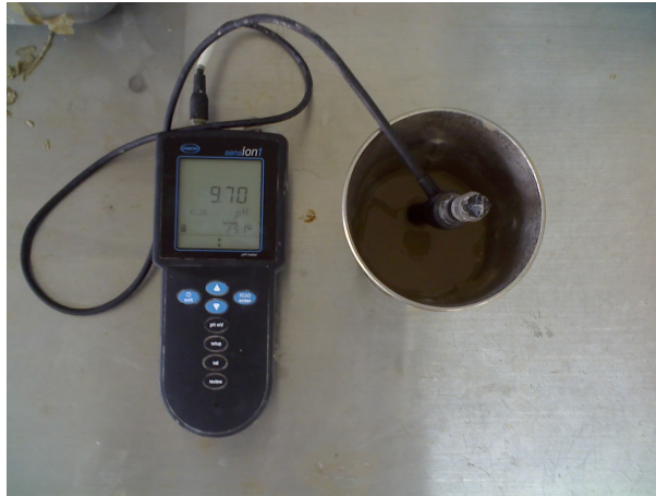
Figura 1.2. Medidor electrónico de pH
