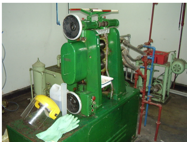
Figura 4.7. Maquina Extrusora de Rodillos Berstor AF.
