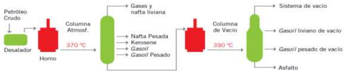
Figura 2. Unidad de procesamiento de crudos.
