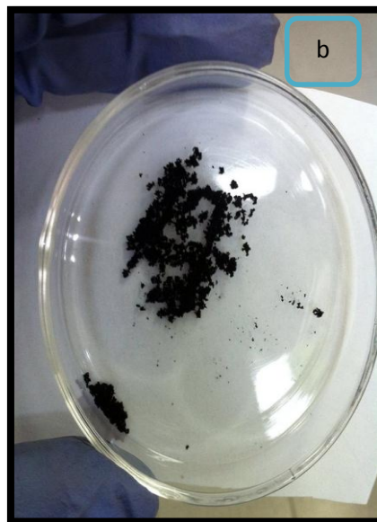
Figura 6: a) Inmovilización del líquido iónico sobre la matriz de carbón activado, b) Carbón con el líquido iónico inmovilizado.
