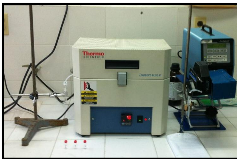
Figura 10. Montaje de desulfuración con variación de temperatura.
