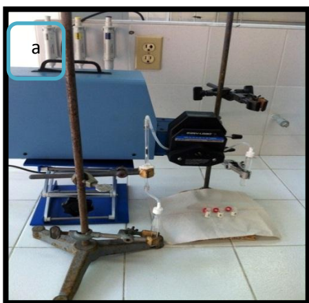
Figura 9: a) Montaje para desulfuración, b) Carbón con el líquido iónico inmovilizado (adsorbente).
