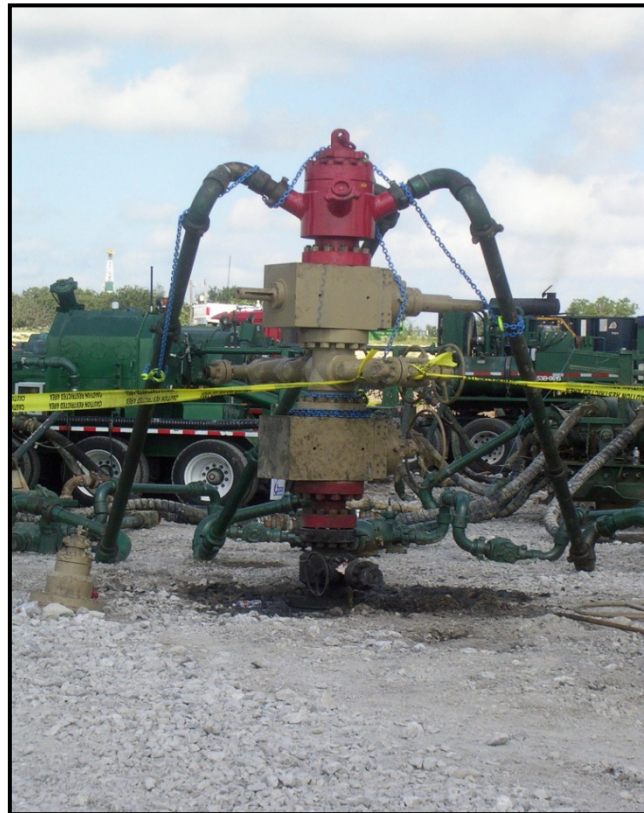
Figura 12. Cabezal de Pozo (wellhead)
