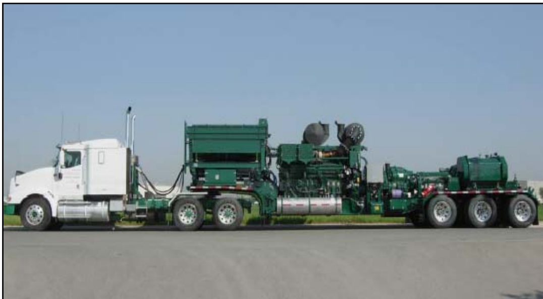
Figura 11. Fracturadores o Bombeadores.
