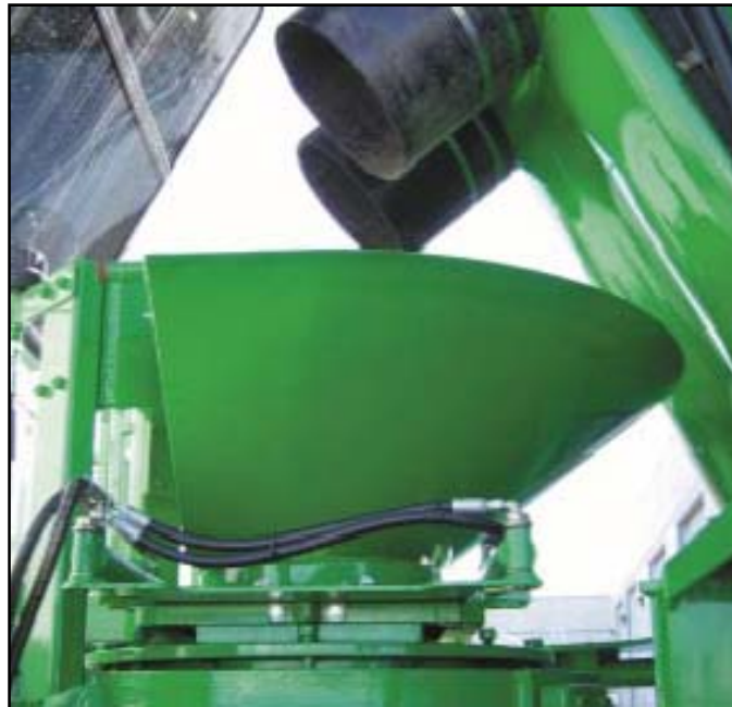
Figura 10. Tanque de Mezcla.
