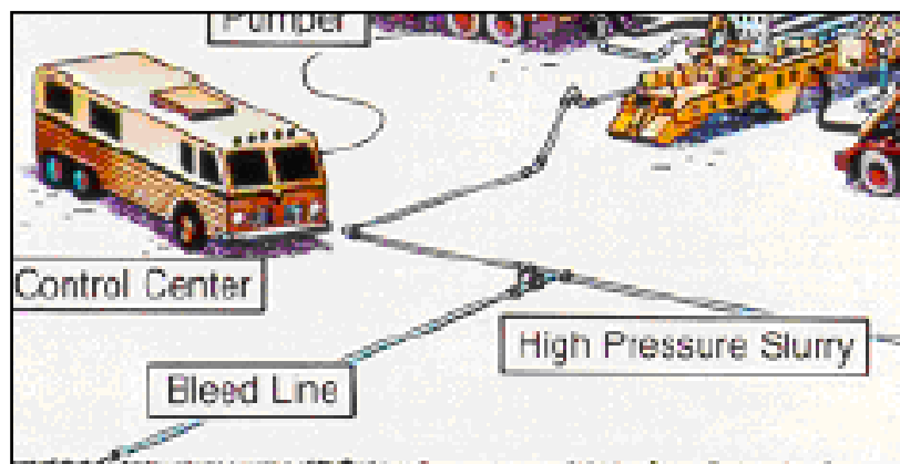
Figura 19. Líneas de alta presión y frac van
