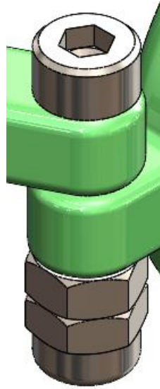
Figura 35. Unión de perno y contratuerca
