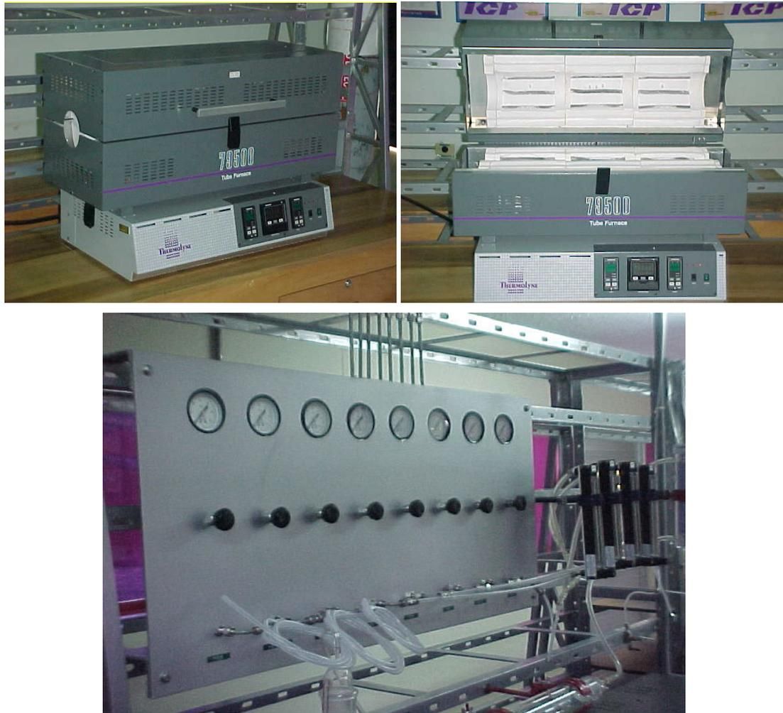
**Calibración de Fluómetros.** Se implementó una técnica para la calibración que se fundamenta en el sistema simple de desplazamiento de una burbuja por la presencia de un gas.
