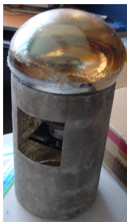
(a) Base para el PMT con una apertura para facilitar el acceso a los puertos de control y señal.
