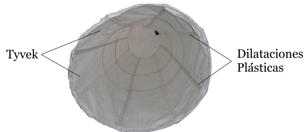
Figura 4.3: Difusor interno (Tyvek) empleado en Guane-1. El armazón de tiras plásticas forma una estructura con iguales dimensiones al TD que mantiene el Tyvek sujeto a las paredes de éste.
