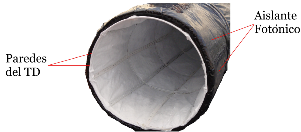
Figura 4.4: Aislante fotónico, ubicado al exterior e interior del TD, entre el difusor interno y las paredes del tanque.
