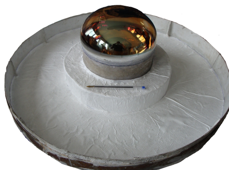
(b) Tapa del tanque detector diseñada para sellar el tanque y funcionar como base para el PMT. Tapizada en Tyvek
