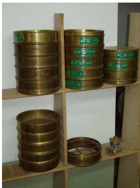
Figura 24. Tamices del laboratorio para el ensayo de granulometría
