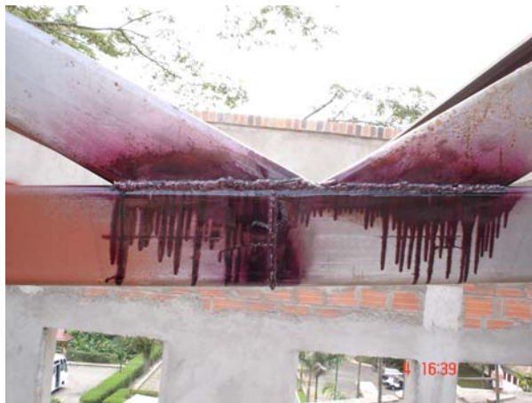
Figura 34. Efecto de aplicación de tinta reveladora.
