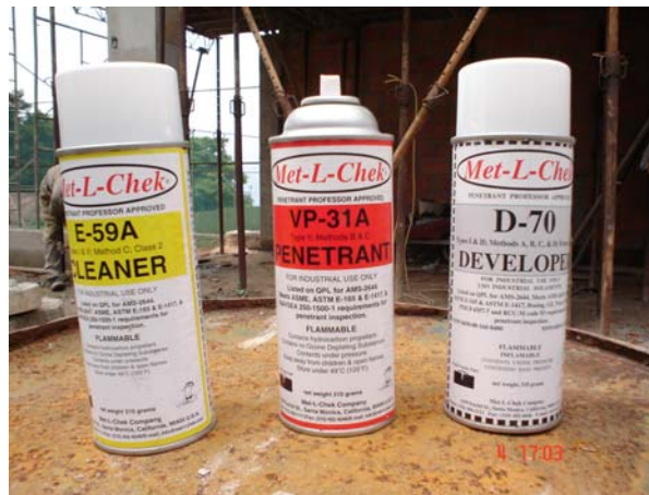
Figura 31. Detalle tintas usadas en ensayo
