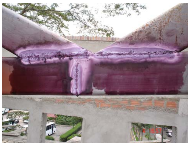
Figura 34. Efecto de aplicación de tinta reveladora.
