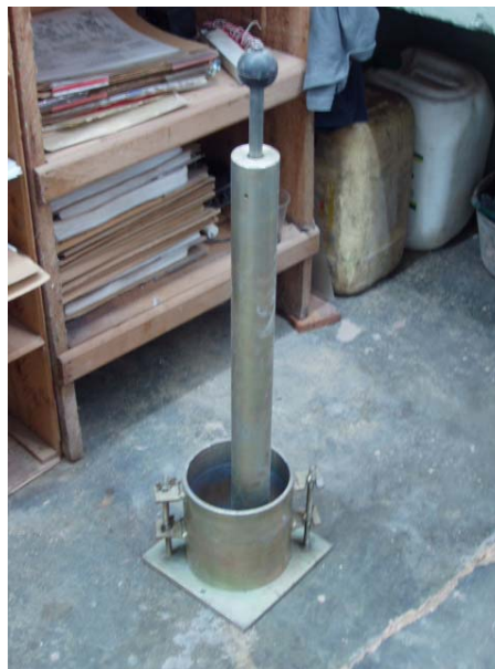
Figura 23. Ensayo de Proctor modificado
