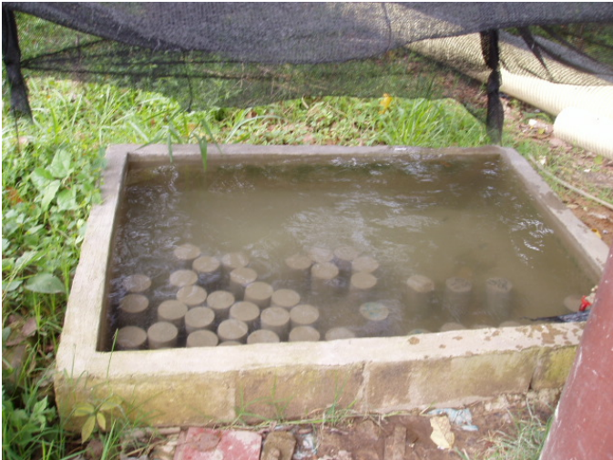
Figura 29. Curado de las muestras de concreto
