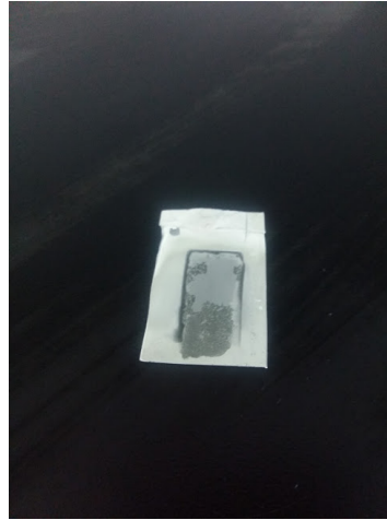
Figura 13: Apariencia de lámina de aluminio una vez finalizado el proceso de anodización en ácido sulfúrico 0.3 M
