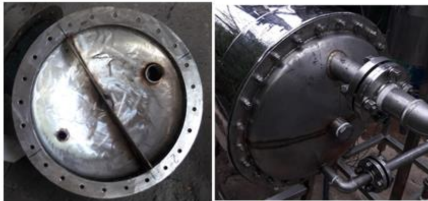
Figura 18. Cabezal frontal con placa de separación para 2 pasos.
