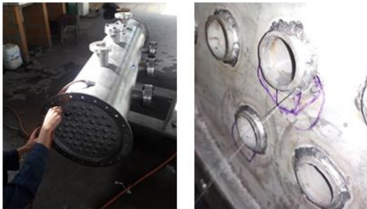
Figura 41. Prueba hidrostática evaporador-condensador.
