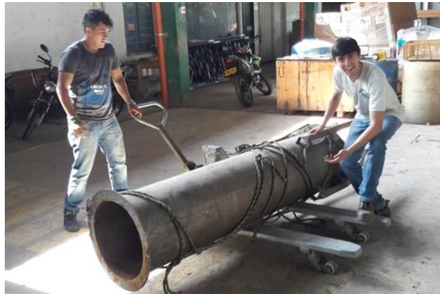
Figura 13. Tanque reutilizado para coraza de evaporador-condensador.
