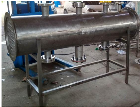
Figura 21. Estructura de soporte para el evaporador-condensador.
