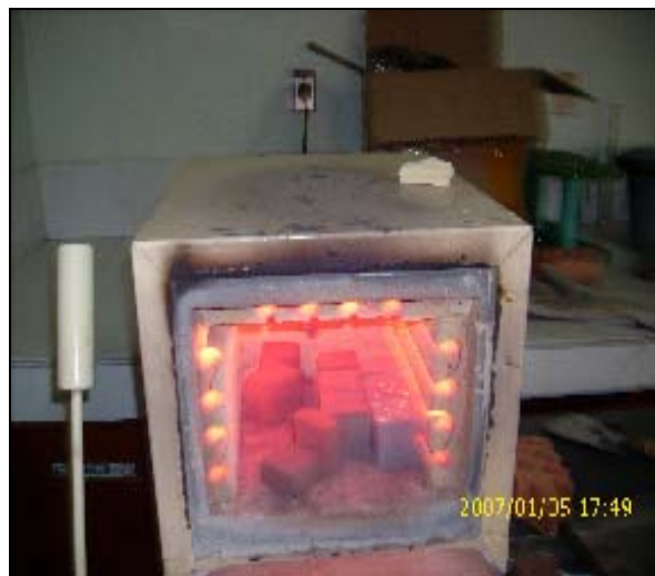
Figura 12. Morteros sometidos a altas temperaturas en el Horno d8 serie 783 terrígeno.
