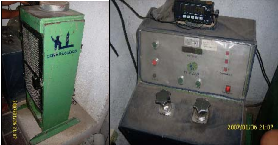
Figura 11. Máquina para la compresión de las probetas de morteros geopoliméricos.
