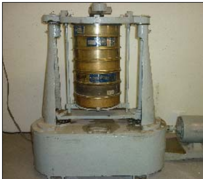
Figura 3. Agitador de tamiz, para determinar la granulometría.
