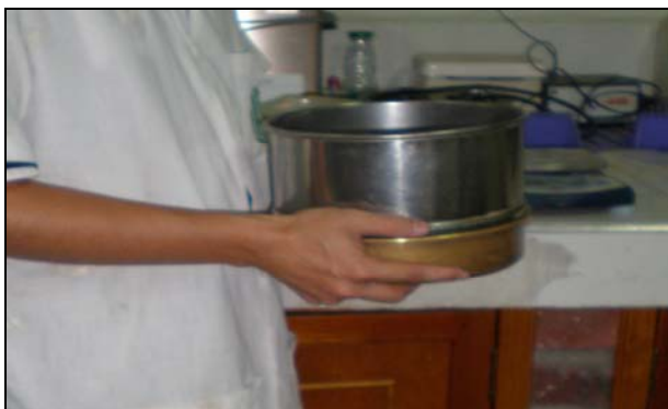
Figura 5. Determinación de la finura del cemento por el tamiz 200
