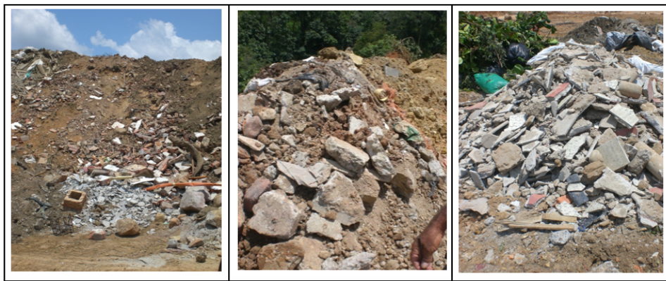
Figura 45. Escombros provenientes de construcción.
