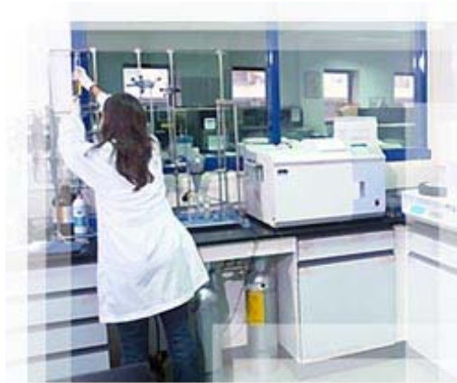
Figura 229. Seguimiento de los gases disueltos en los aceites
