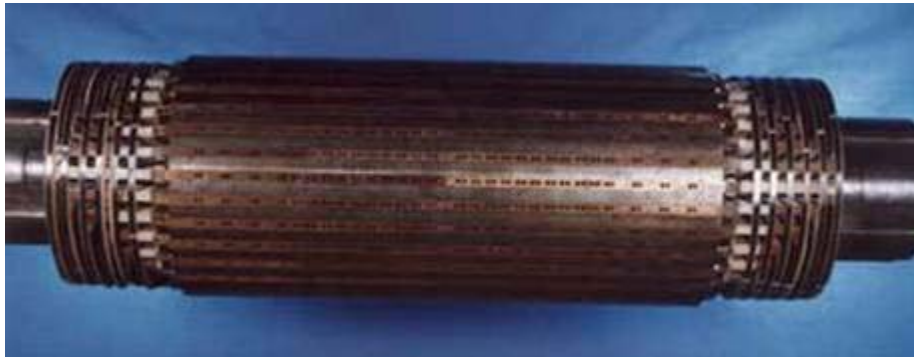
Figura 159. Problema mecánico por eje torcido
