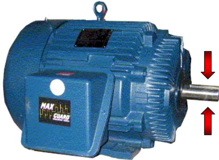
Figura 160. Verificación del estado de los cojinetes
