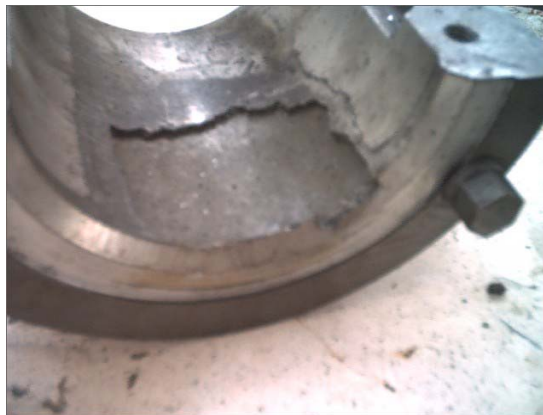
Figura 168. Falla típica de cojinete por mal ajuste
