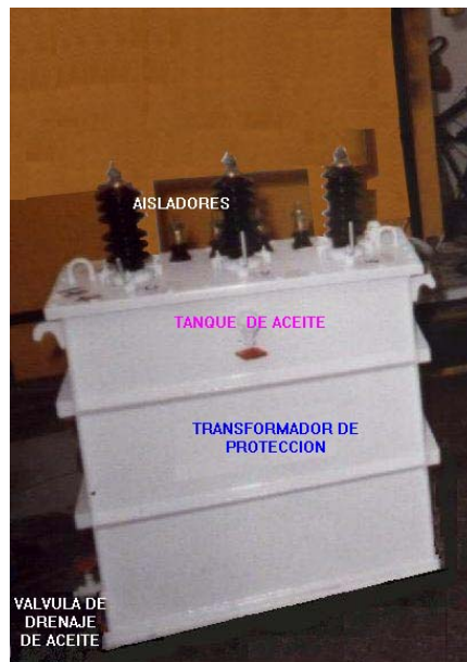
Figura 215. Transformador de Protección
