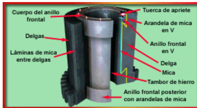
Figura 75. Colector de motor de corriente directa
