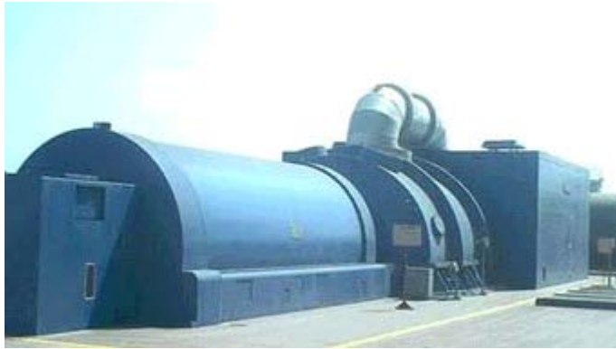
Figura 247. Fotografía de un generador totalmente cerrado con enfriamiento de aire a agua
