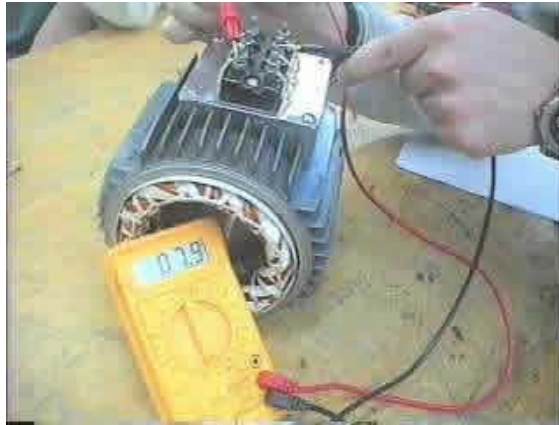
Figura 154. Verificando conexiones internas en motores eléctricos
