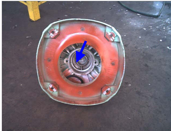
Figura 167. Escudo con las pistas desgastadas
