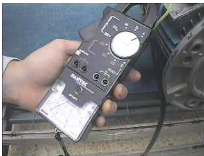
Figura 122. Verificación de la corriente en un motor trifásico
