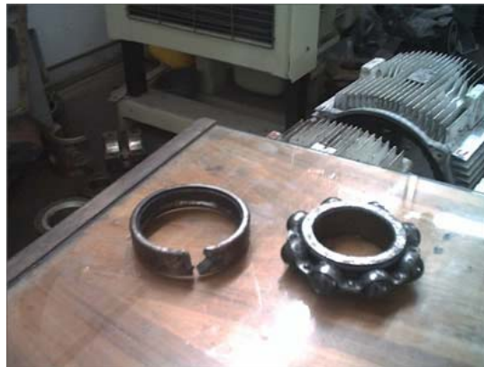
Figura 135. Falla típica en radamiento
