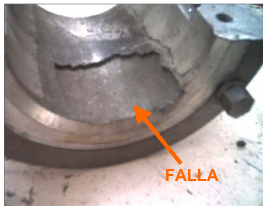
Figura 269. Cojinete Falta De Lubricación
