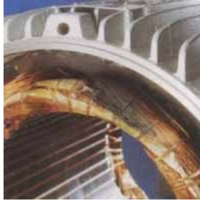
Figura 152. Falla por interrupción en una fase
