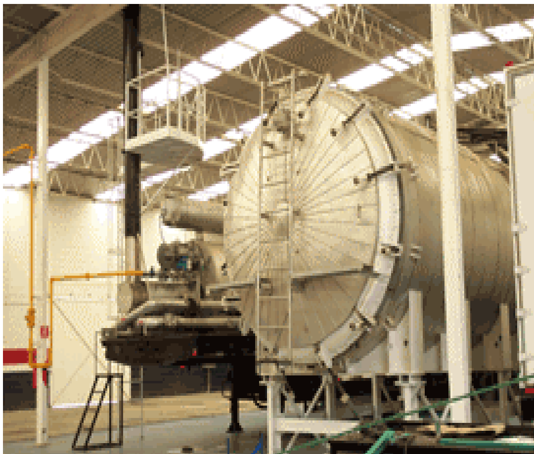
Figura 227. Unidad productora de aceite aislante y refrigerante
