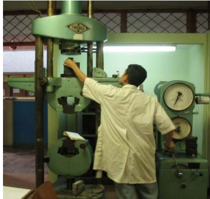
Foto 2.4 Máquina Universal de Ensayos TREBEL, con probeta de compresión
