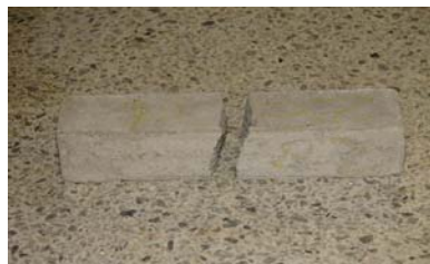
Foto 3. Probeta de Flexión fallada
