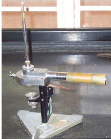
Foto 2.8 Instrumentos para el ensayo de Porosidad
