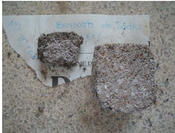
Foto 4. Mortero ferromagnético (M30/70%) con Benzoato de Sodio (28 días)
