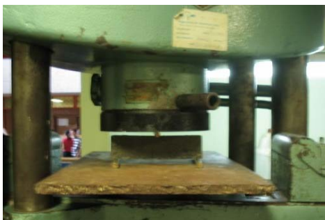
Foto 2.6 Máquina Universal de Ensayos TREBEL, con probeta de flexión
