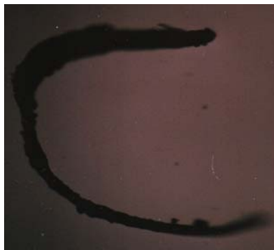
Foto 2.3c. Limadura de acero Malla 50 vista en el microscopio
