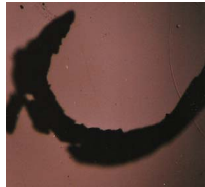
Foto 2.3c. Limadura de acero Malla 50 vista en el microscopio
