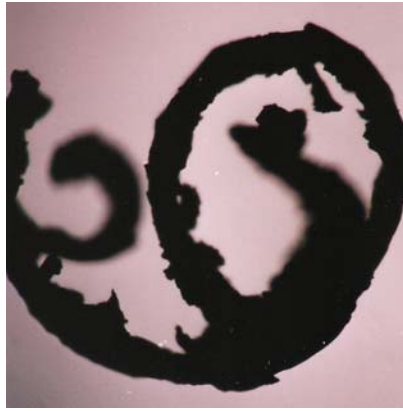
Foto 2.3 b. Limadura de acero Malla 30 vista en el microscopio
