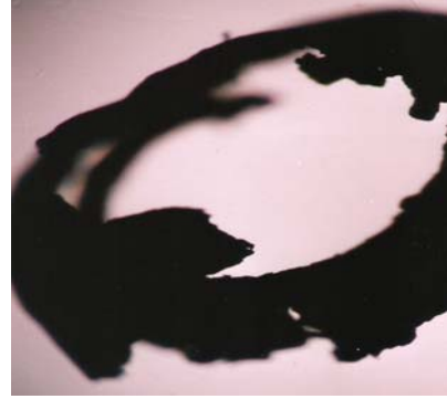
Foto 2.3 b. Limadura de acero Malla 30 vista en el microscopio
