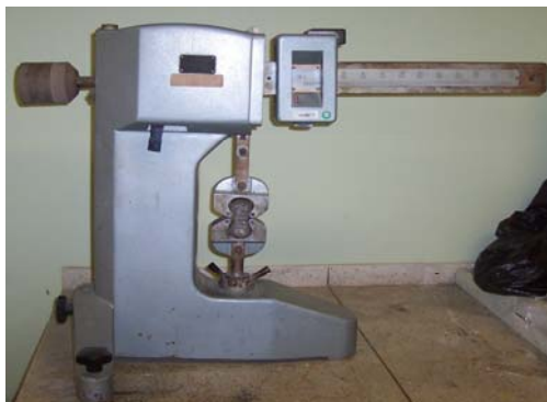
Foto 2.6 Máquina Universal de Ensayos TREBEL, con probeta de flexión
