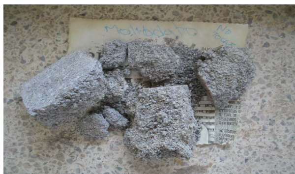
Foto 3. Mortero ferromagnético (M30/70%) con Molibdato de sodio (28 días)
