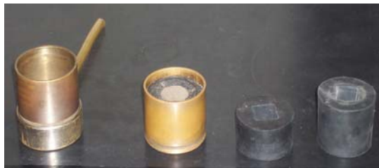
Foto 2.15 Ensayo de Solidez bajo la acción de Sulfatos
