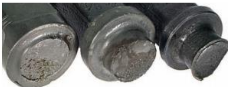
Figura 36. Fallas en el Pin de Varilla
