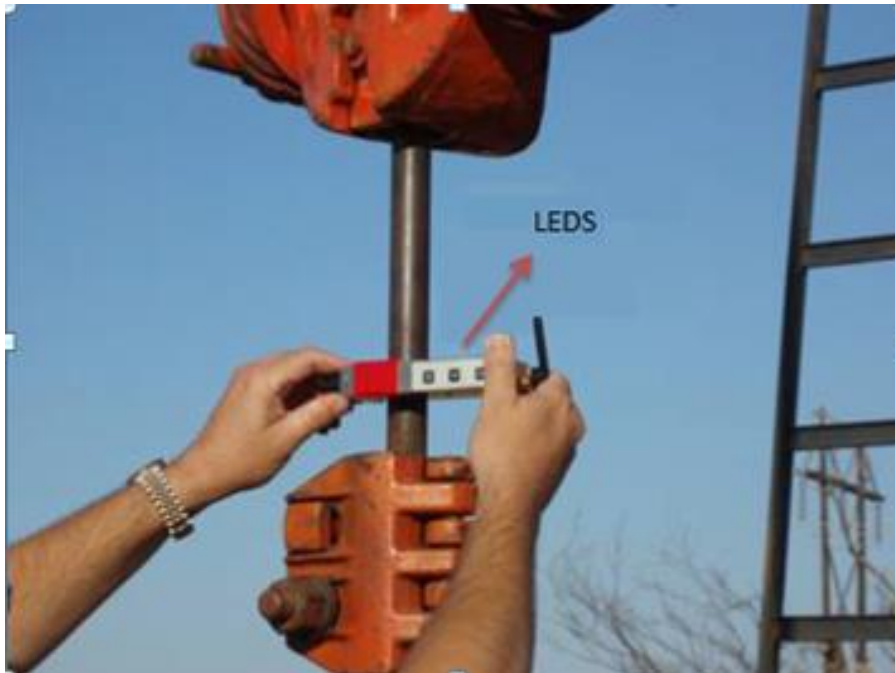
Figura 62. Instalación celda PRT inalámbrica
