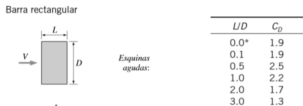
Figura 64. Coeficiente de arrastre de una placa perpendicular al flujo. Tabla11-1 Cengel, Y., & Cimbala, J. (2006). MECANICA DE FLUIDOS. In Statewide Agricultural Land Use Baseline 2015 (Vol. 1). https://doi.org/10.1017/CBO9781107415324.004
