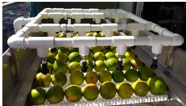
Figura 11. HIDACAM. (n.d.). Lavado con agua a presión. Retrieved December 6, 2019, from Maquina lavadora website: www.hidacamingenieros.com/lavadora-de-frutas-naranjas
