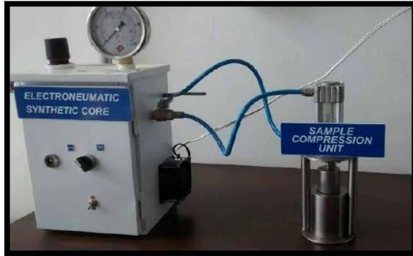
Figura 12. Equipo Electro – Neumático de compactación para muestras sintéticas.
