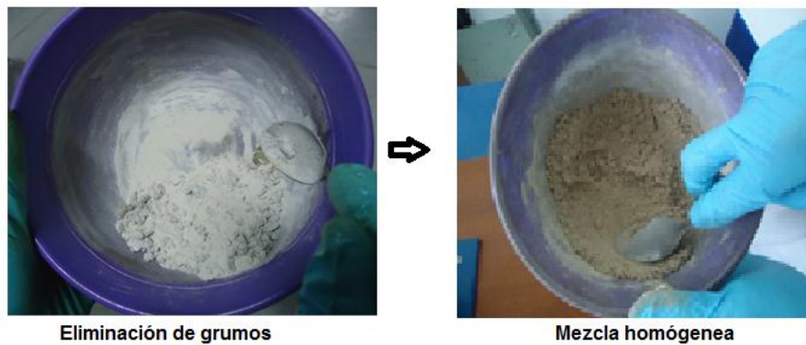
Figura 15. Mezcla de arena caolín con solución epóxica
