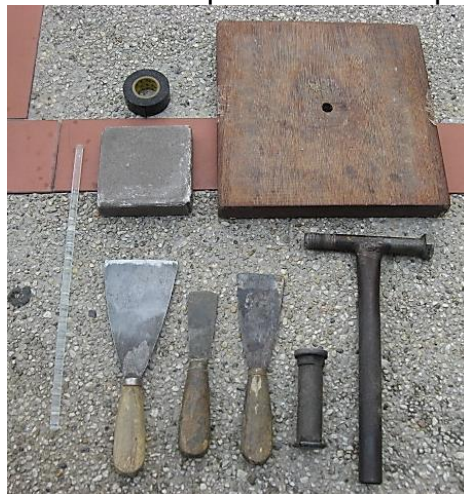
Figura 9. Herramientas utilizadas en el proceso de compactación.
