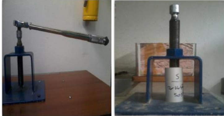
Figura 11. Torquímetro utilizado para la compactación de muestras sintéticas.
