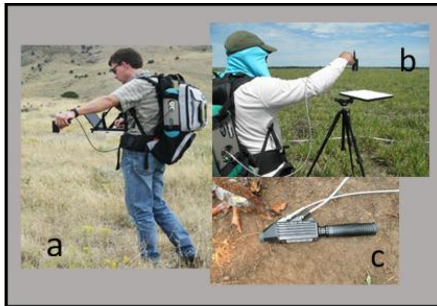
Figura 18. Toma de firmas espectrales en campo, a) Equipo Field Spect ASD; b) Calibración de fibra óptica con espectralon (blanco de referencia); c) Accesorio Contac Probe para toma de firmas en suelos y rocas.
