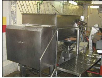
Figura 7. Mezclador de capacidad de 500 kilos
