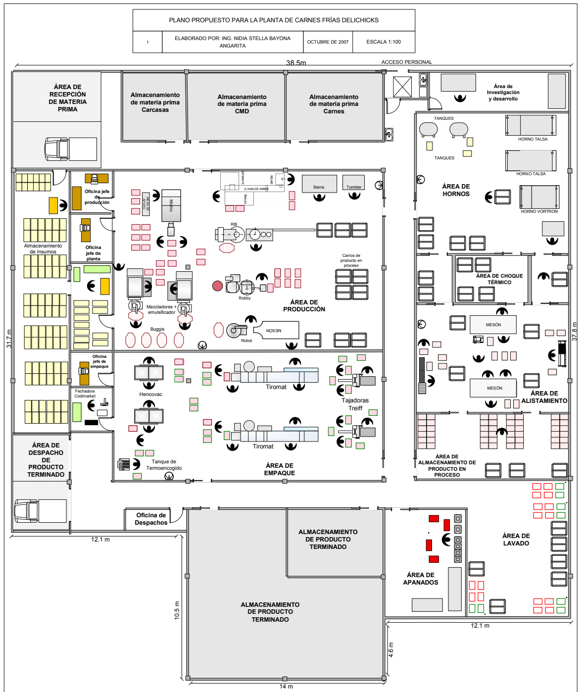
Figura 38. Plano Propuesto de Distribución para la planta.
