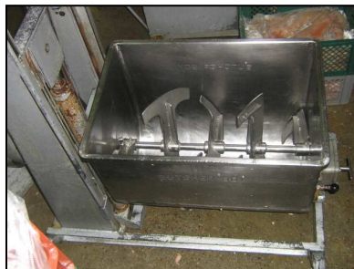
Figura 6. Mezclador de capacidad de 150 kilos
