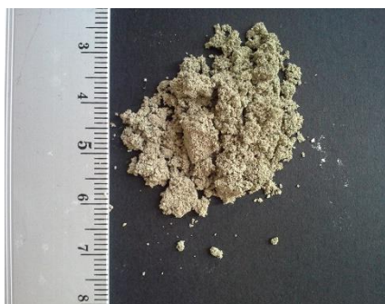
Figura 10. Características del material anódico de las pilas alcalinas.
