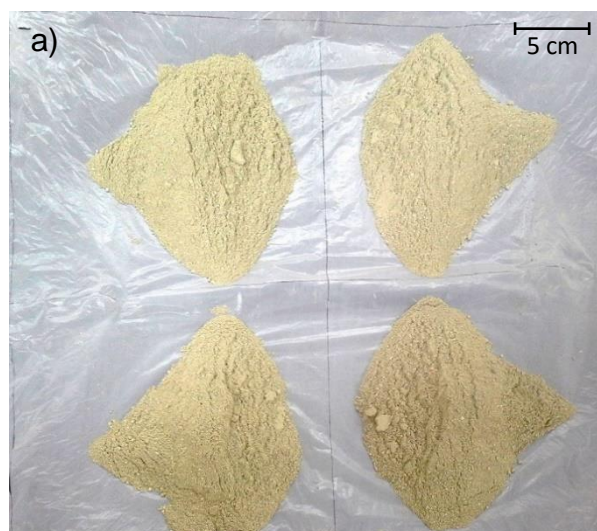
Figura 7. a) Aspecto del material anódico de las pilas alcalinas durante el primer cuarteo b) Esquema general
