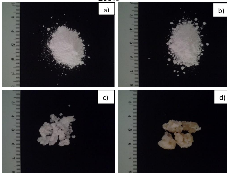
Figura 14. Sales de citrato de zinc obtenidas de lixiviación: a) subestequiométrica 50% b) estequiométrica c) supraestequiométrica 115% d) supraestequiométrica 200%
