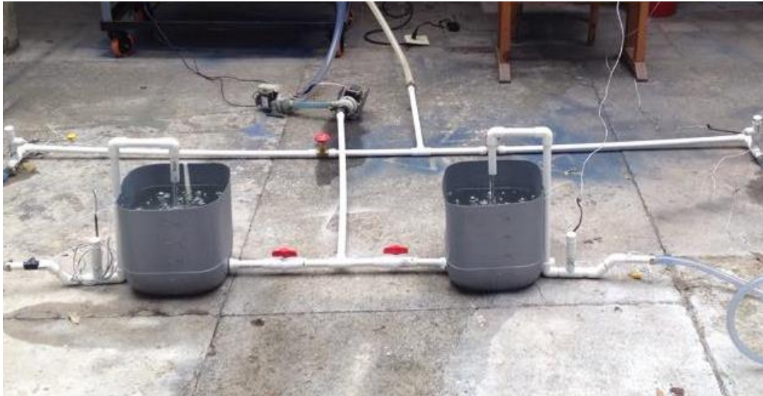
Figura 21. Sistema de extracción de volumen para medición indirecta de caudal
