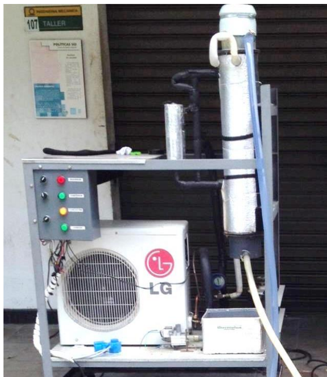
Figura 16. Sistema de refrigeración adaptado
