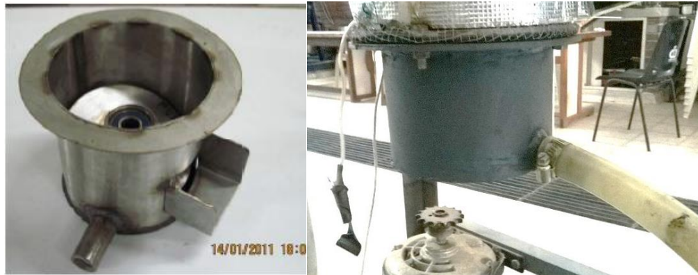
Figura 15. Adaptación de la tapa para el sistema de bombeo
