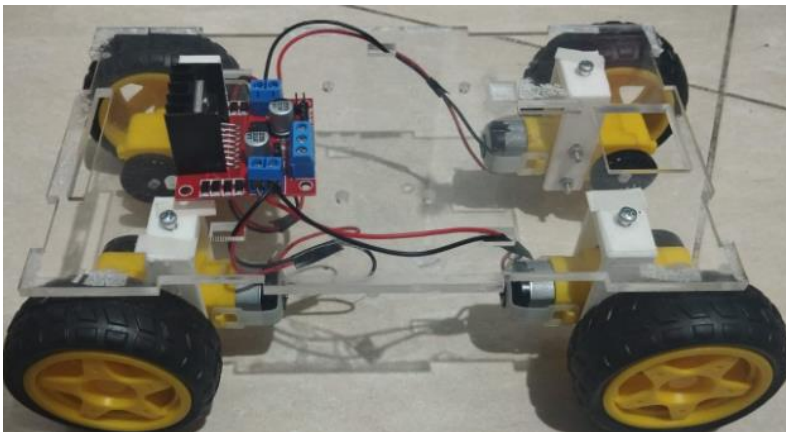
Figura 20. Montaje de soportes de motor con el controlador Lm298N
