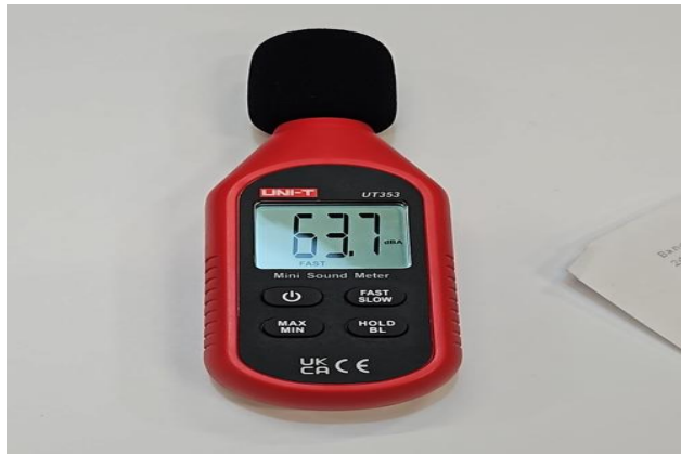
Ilustración 21. Medición de nivel de presión sonora en zona de trabajo con sonómetro digital
