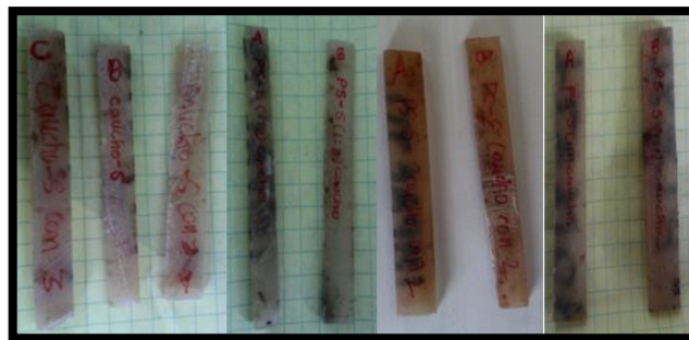
Figura 38. Probetas usadas para el ensayo de Flexión
