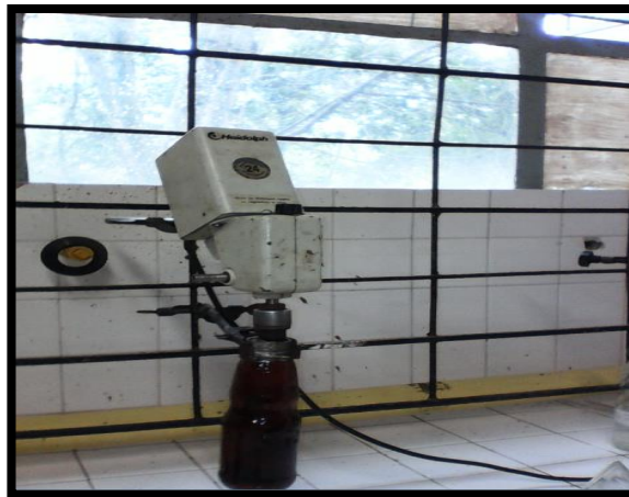
Figura 11. Agitación a motor de la dispersión Caucho-S
