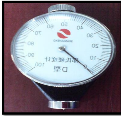
Figura 16. Durómetro tipo D
