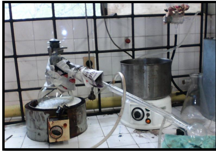
Figura 8. Eliminación de los Inhibidores en el MMA
