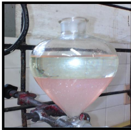
Figura 6. Lavado del Estireno para la eliminación de los Inhibidores
