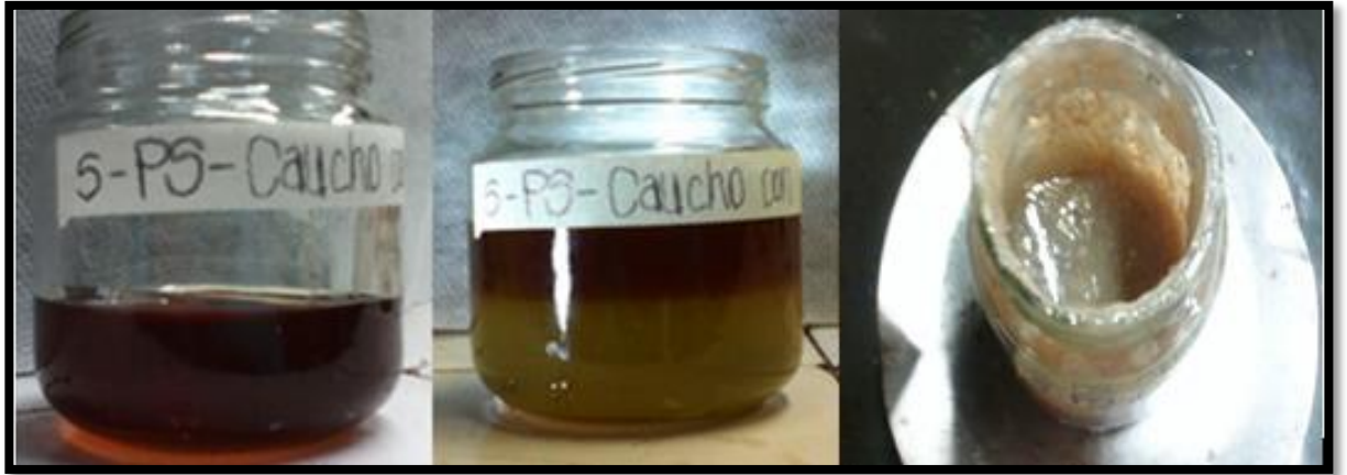
Figura 20. Polimerización de la muestras Caucho-S, S-PS, S-PS-Caucho, a mayores proporciones
