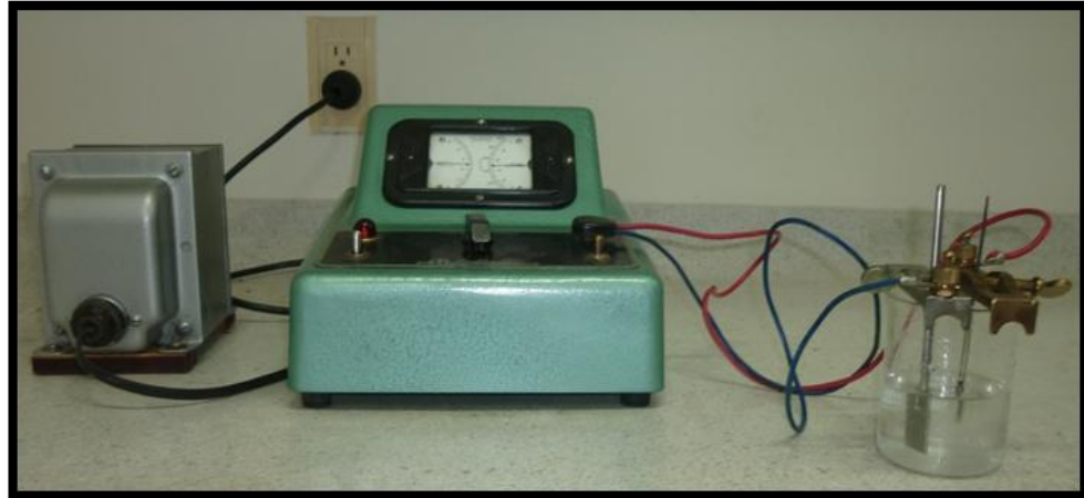
Fotografía 1. Ataque electrolítico, laboratorio metalografía sede UIS
