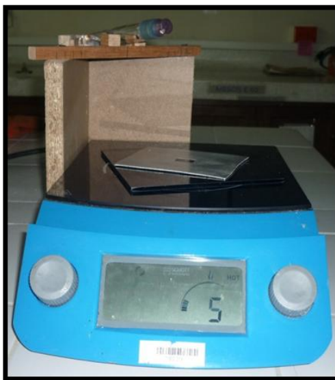
Fotografía 3. Simulación de aplicación del depósito \text{K}_2\text{SO}_4 - \text{NaCl}
