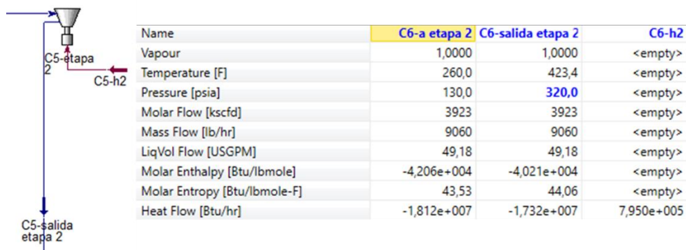
Figura 9. Sección de enfriamiento de segunda etapa
