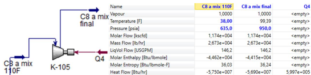
Figura 34. Sistema de compresión post intercambiador gas – gas etapa 3 – alternativa 2.
