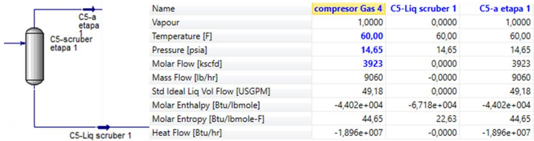
Figura 4. Separador bifásico de primera etapa
